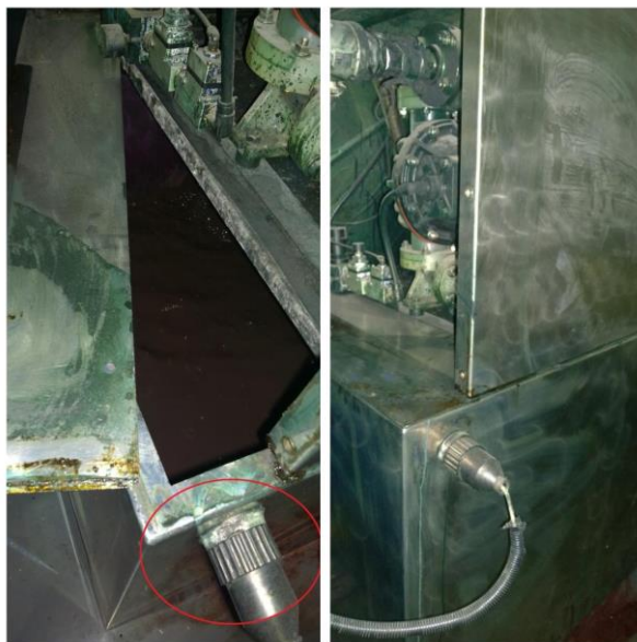
Слика 10. Пуњење отпадног резервоара на штампарској машини и приказ сензора
