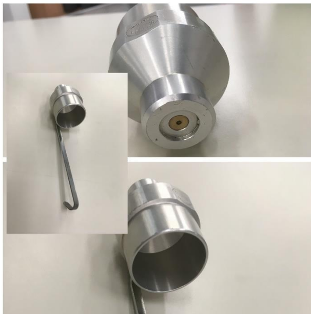
Слика 37. Кутлача за мерење вискозности растварача
