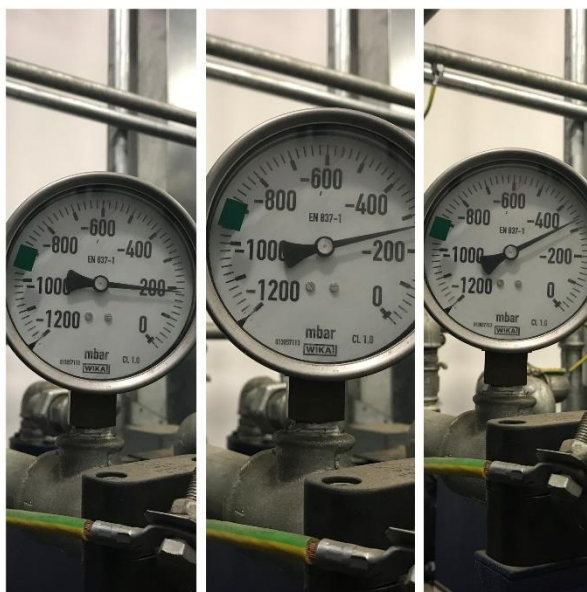
Слика 44. Вакуумметар за мерење потпритиска
