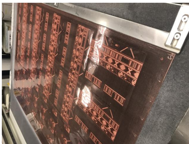
Слика 38. Завршено клише са задатом формом
