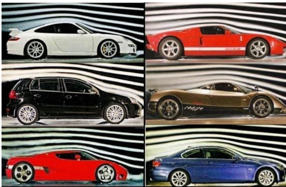
Слика 17. – Дејство отпора ваздуха на различитим типовима возила
