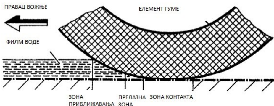
Слика 14. - Фазе истискивања воде при вожњи по мокром путу [5]
