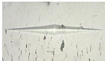
Слика 77. Отисак Кнуповог утискивача на превлаци тврдог хрома
