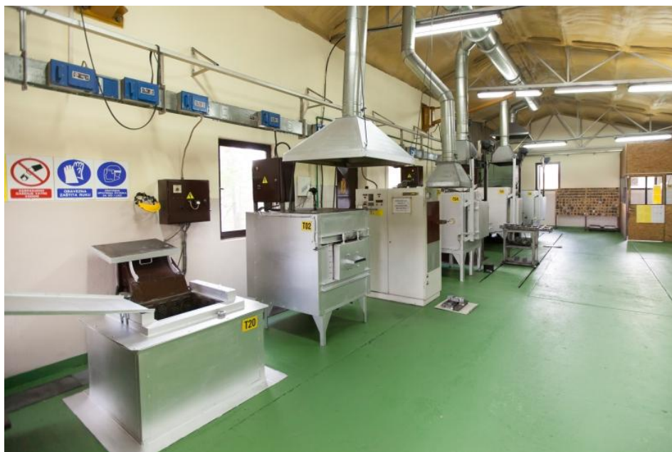
Слика 48. Пример савременог постројења за термичку обраду (каљење + отпуштање)
