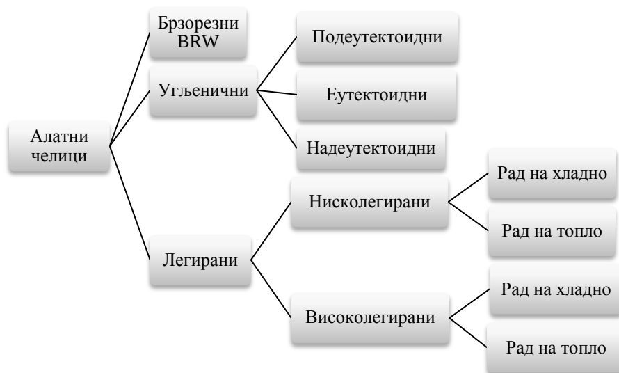
Слика 38. Схема поделе алатних челика
