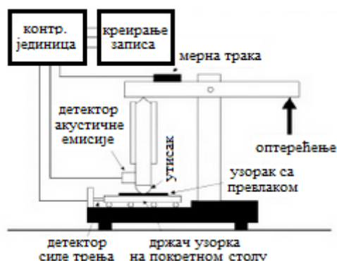
Слика 86. Схема и изглед уређаја за испитивање адхезије превлака (scratch-tester)
