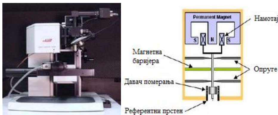
Слика 83. Изглед и схема ННТ ( Nano Hardness Tester ) уређаја
