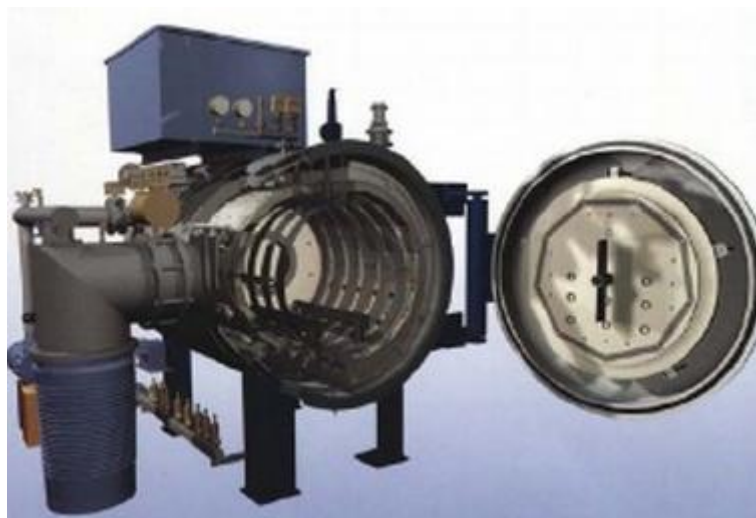
Слика 46. Једнокоморна вакуумска пећ; Карактеристике пећи: вакуум до 10^{-4} bara, максимална радна температура 1350^{\circ}\text{C} ; хлађење у гасовима \text{N}_2 , Ar, He, \text{H}_2 ; хлађење у смеши гасова
