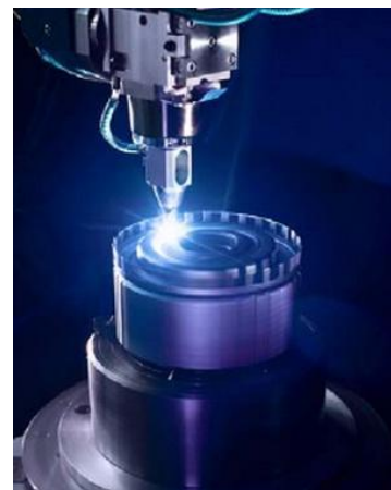
Слика 31. Каљење ласером
