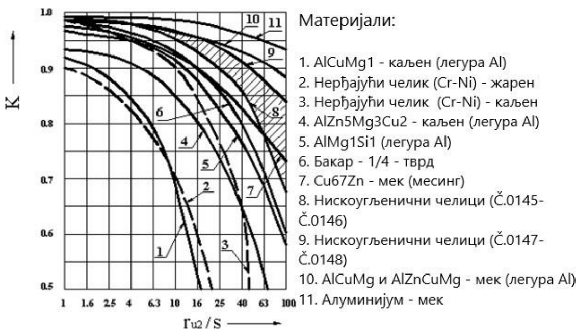
Слика 3.5. Фактор еластичног исправљања по Sachs -у за различите материјале [5]
