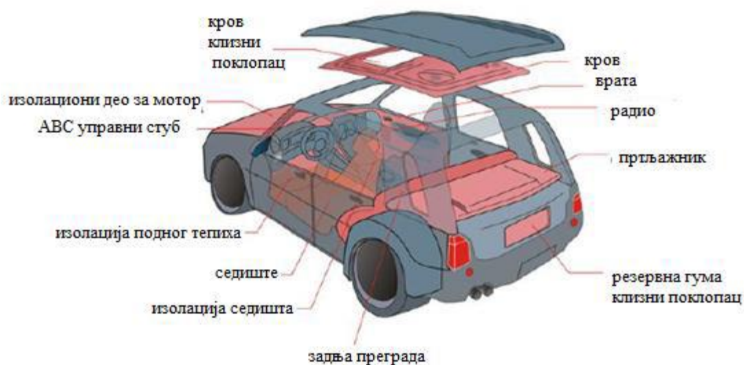
Слика 6.1. – Делови каросерије путничкох аутомобила направљени од полимерних материјала [13]
