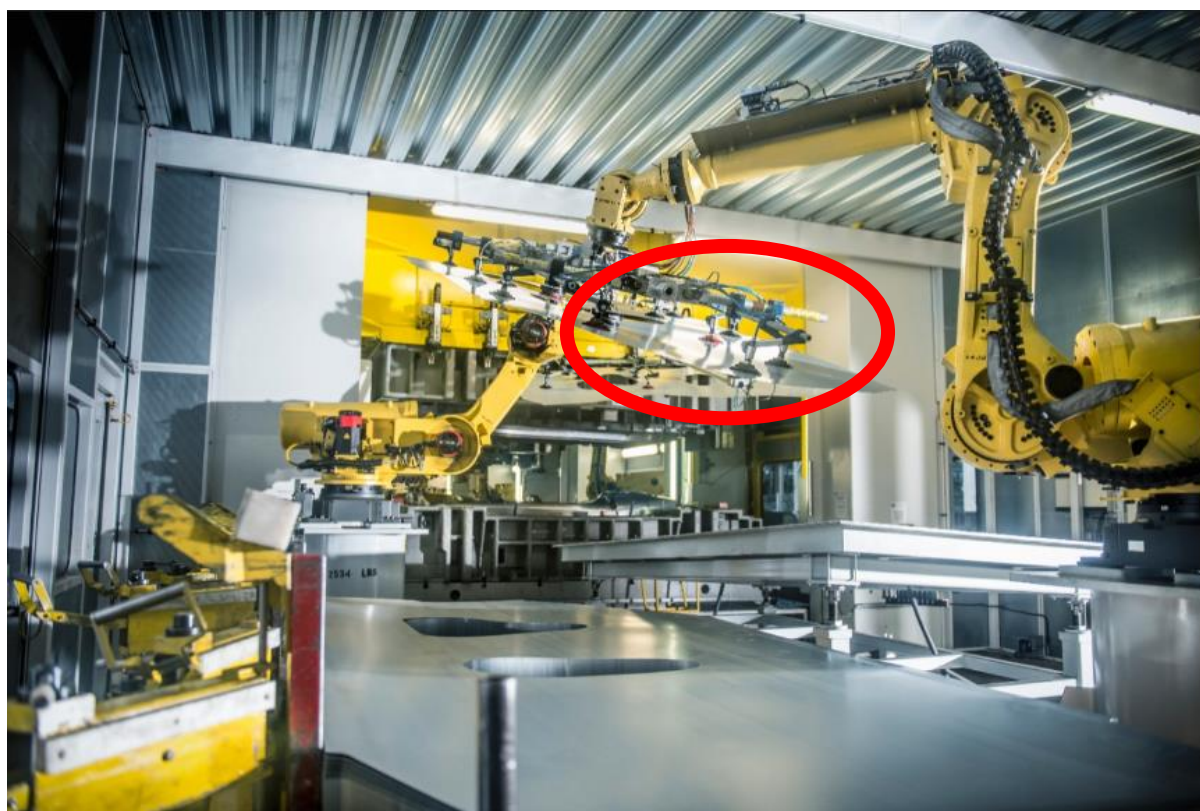
Слика 8.1. – Машина за раслојавање лима помоћу вакуумских капа (вентоза) [39]
