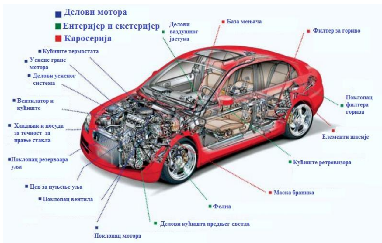
Слика 1.1. – Делови аутомобила направљени од полимера [2]
