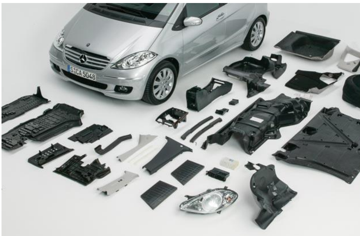
Слика 6.2. – Различити унутрашњи делови путничкох аутомобила направљени од полимерних материјала [11]
