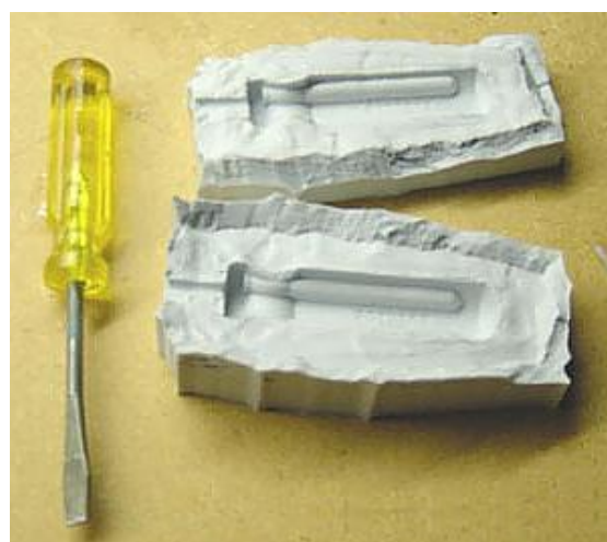
Слика 3.4. – Поступак ливења и готов производ [3]
