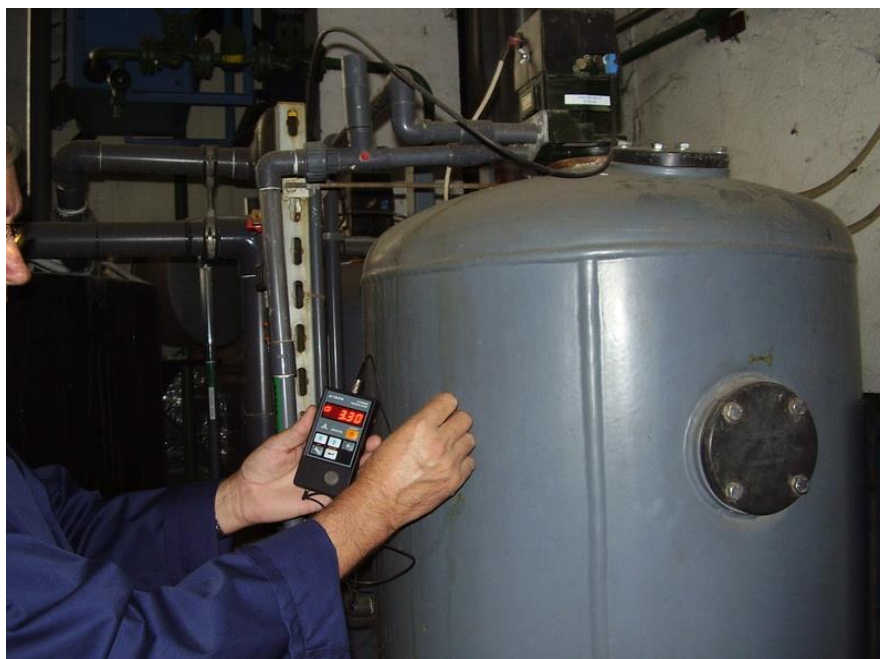
Слика 2.10 - Контрола дебљине зида вертикалне посуде под притиском
