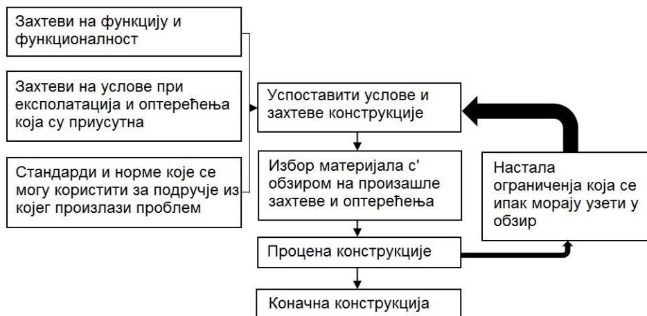
Слика 2.2 Шема процедуре осмишљавања конструкције суда под притиском
