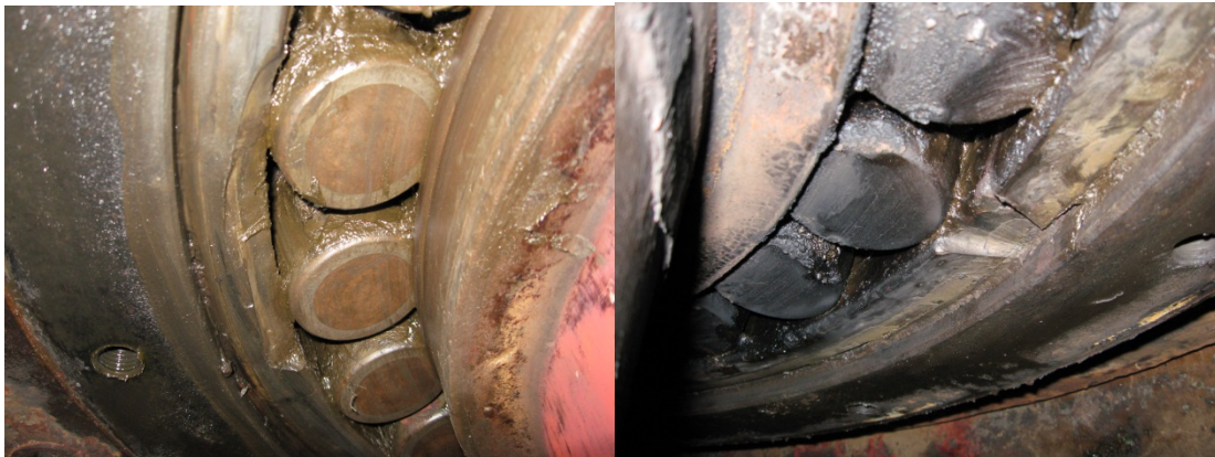
Слика 4.1 – Изглед оштећеног лежаја
