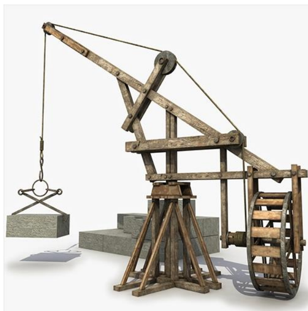
Слика 2.1 Грчки тип дизалице са катуром [4]
