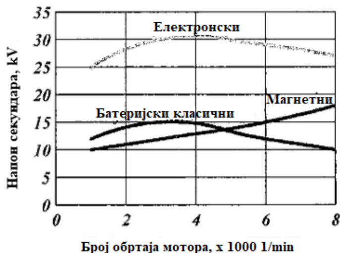
Слика 2: Напон секундара код различитих система паљења[2]
