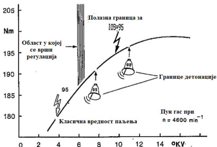
Слика 49: Подешавање претпаљења према квалитету горива[2]
