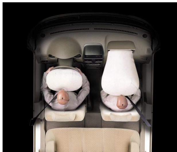
Слика 9 – Активирање возачког и сувозачког ваздушног јастука [5]
