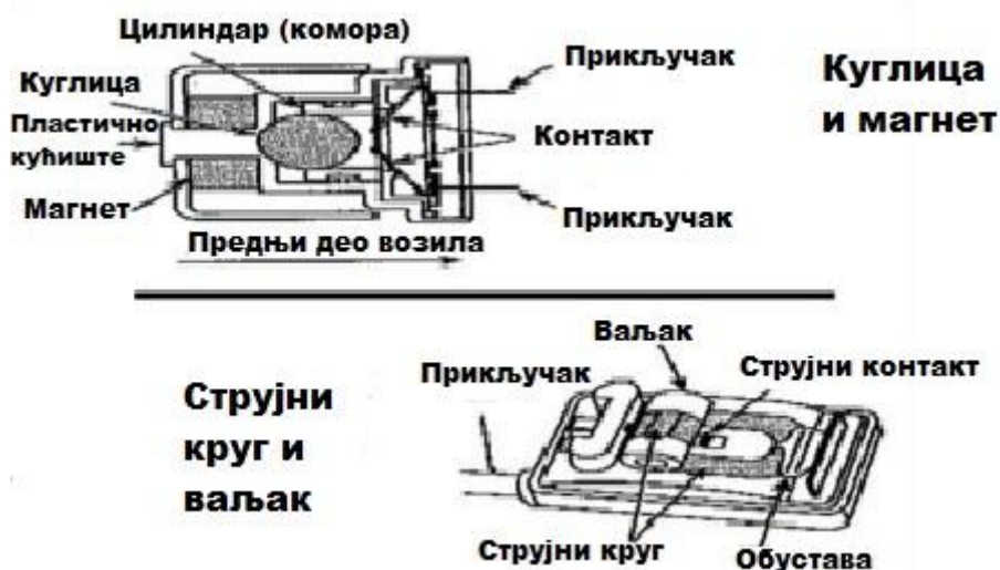
Слика 16 – Шема основних елемената сензора судара [5]
