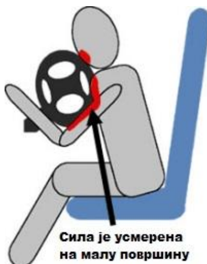
Слика 31 – Код судара без ваздушних јастука површина удара је мала и изазива тешке телесне повреде [12]
