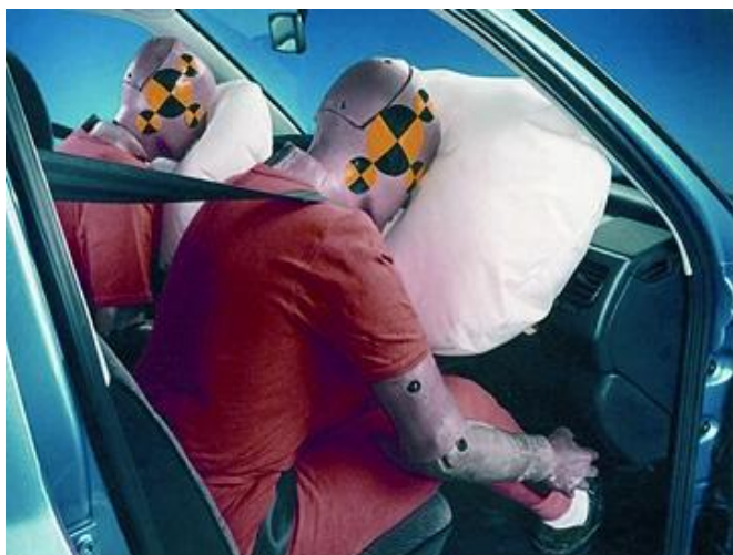
Слика 9 – Активирање возачког и сувозачког ваздушног јастука [5]
