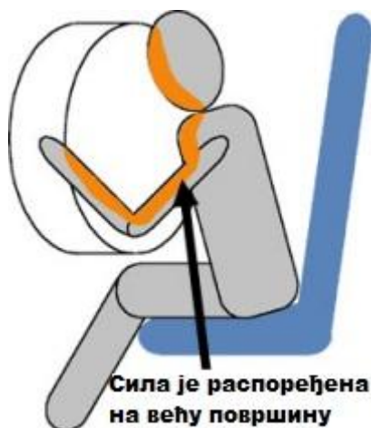
Слика 32 – Код судара са активираним ваздушним јастуцима површина удара је повећана и мекша, па су мање шансе за настанак тешких телесних повреда [12]
