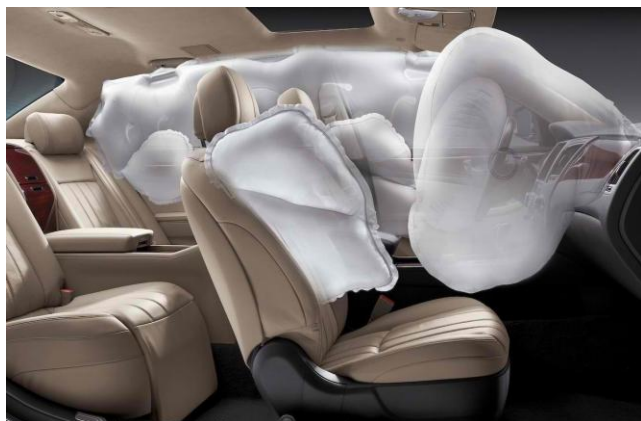
Слика 2 – Приказ бочних јастука, за возача и сувозача ваздушни јастуци [4]
