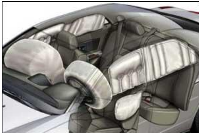
Слика 37 – Позиције ваздушних јастука и ваздушних завеса у данашњим аутомобилима
