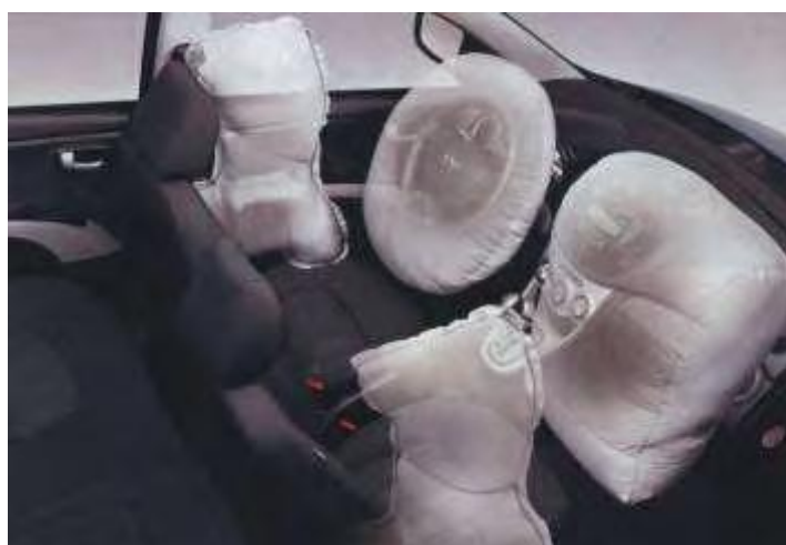
Слика 23 – Ваздушни јастуци возача и сувозача [4]
