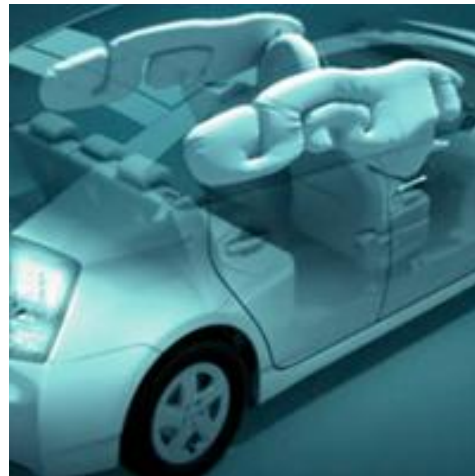
Слика 37 – Позиције ваздушних јастука и ваздушних завеса у данашњим аутомобилима
