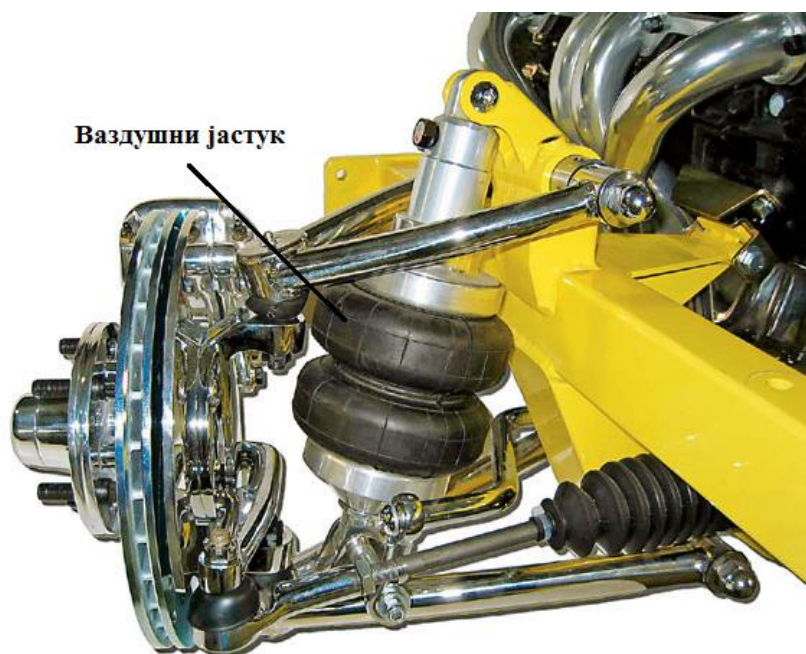
Слика 10. Пнеуматско ослањање у систему са двоструком виљушком (Double wishbone) [10]
