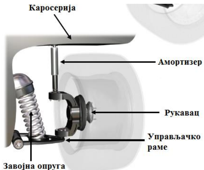
Слика 22. Неконвенционалан MacPherson систем [17]
