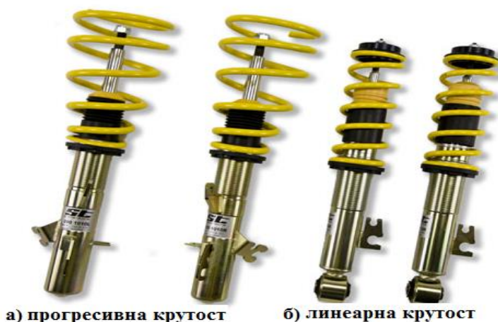
Слика 7. Завојне опруге: а) са прогресивном крутошћу б) са линеарном крутошћу [7]
