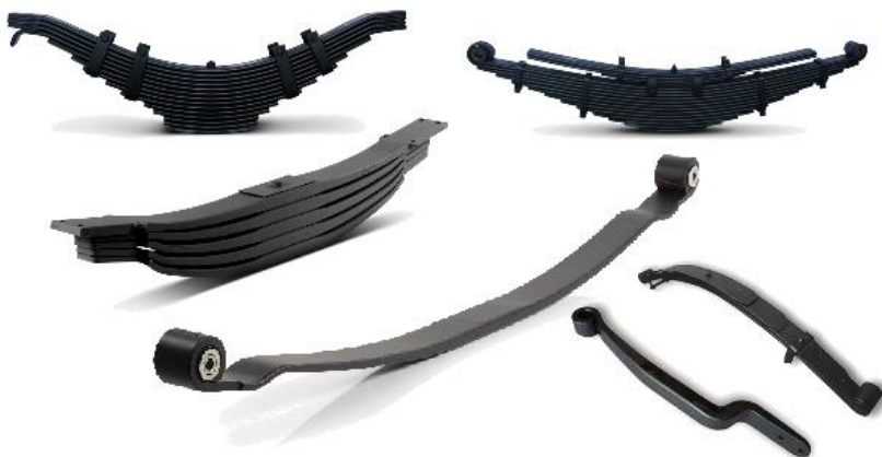
Слика 6. Различита извођења лиснатих гибњева [6]
