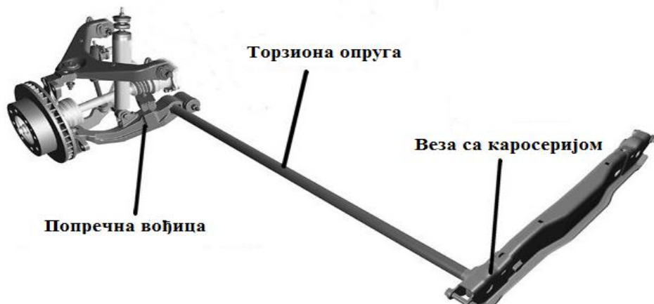
Слика 8. Торзиона опруга у CEO са двоструком виљушком (Double wishbone) [8]
