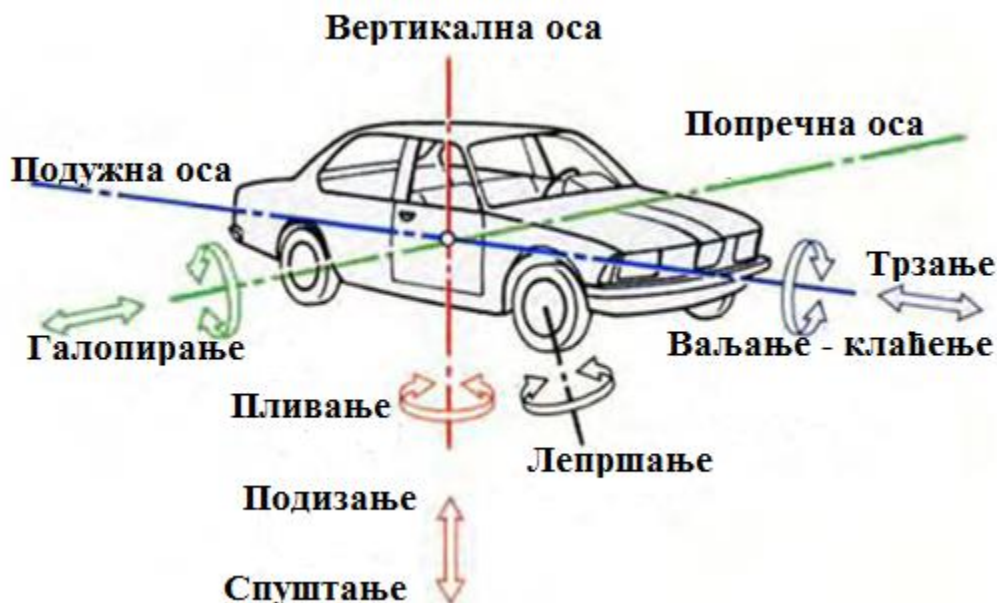
Слика 2. Приказ претпостављених и предвиђених кретања маса возила [4]
