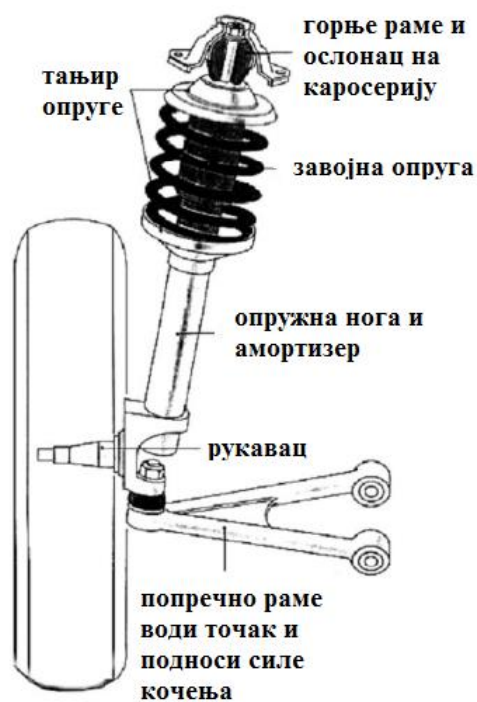
Слика 21. MacPherson опружна нога [1]
