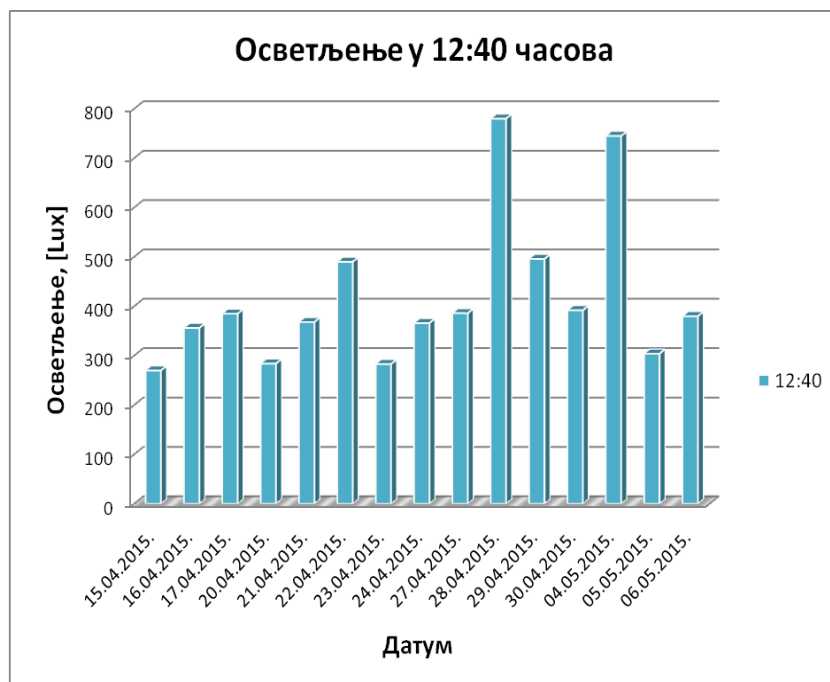
Слика 4.3.1 Измерено осветљење у канцеларији у 12:25 часова
