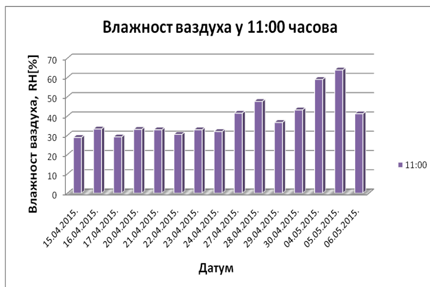
Слика 4.5.1 Измерена влажност ваздуха у радионици у 11 часова
