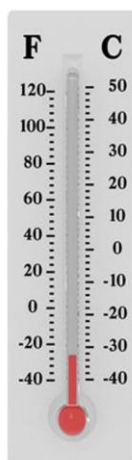
Слика 2.1.3 Класичан живин термометар [13]
