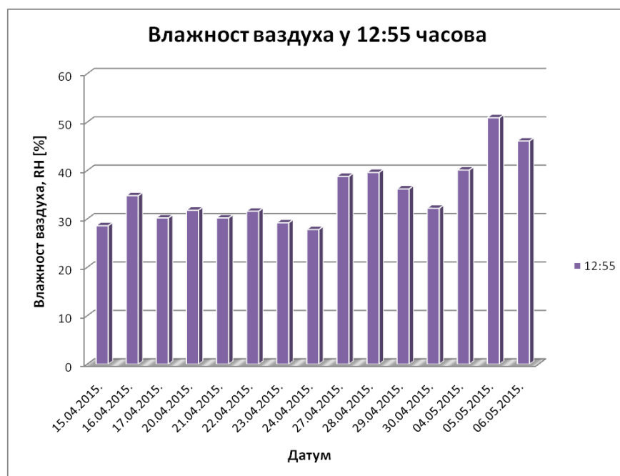
Слика 4.2.3 Измерена влажност ваздуха у канцеларији у 12:55 часова
