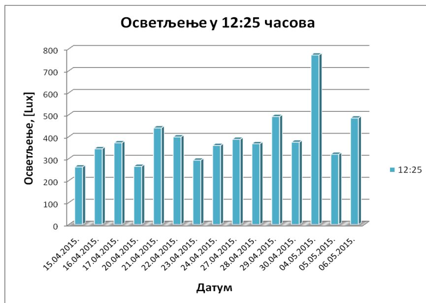
Слика 4.3.1 Измерено осветљење у канцеларији у 12:25 часова
