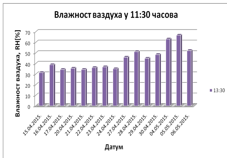
Слика 4.5.3 Измерена влажност ваздуха у радионици у 11:30 часова
