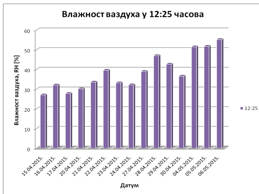
Слика 4.2.1 Измерена влажност ваздуха у канцеларији у 12:25 часова
