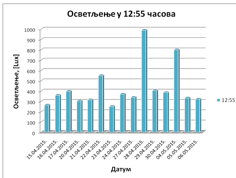
Слика 4.3.3 Измерено осветљење у канцеларији у 12:55 часова
