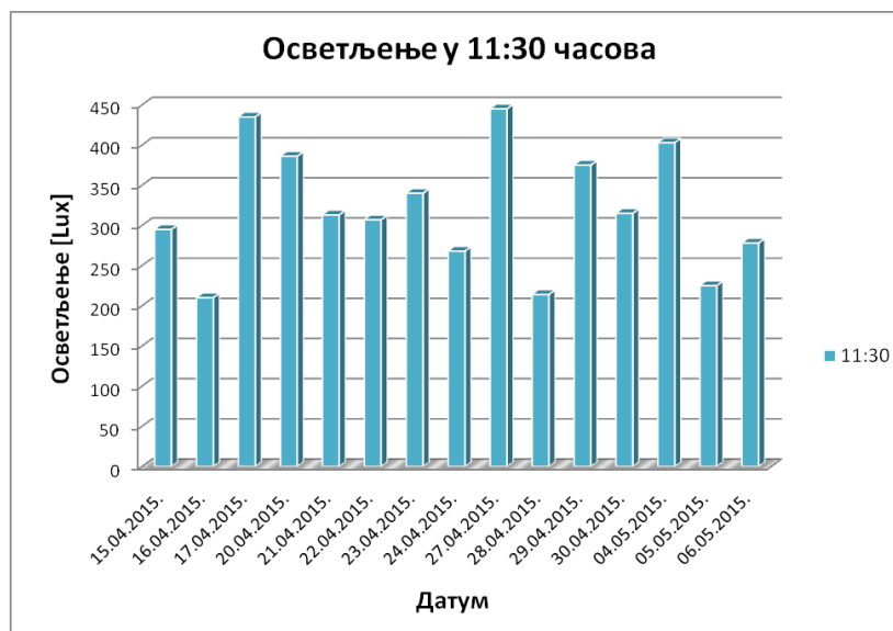
Слика 4.6.3 Измерено осветљење у радионици у 11.30 часова
