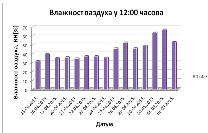
Слика 4.5.5 Измерена влажност ваздуха у радионици у 12 часова
