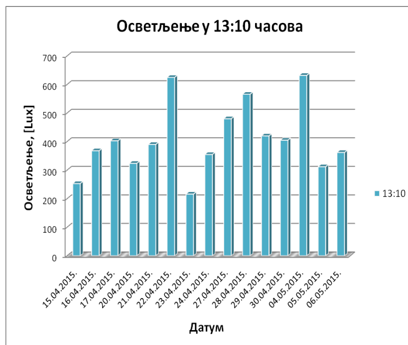
Слика 4.3.4 Измерено осветљење у канцеларији у 13:10 часова
