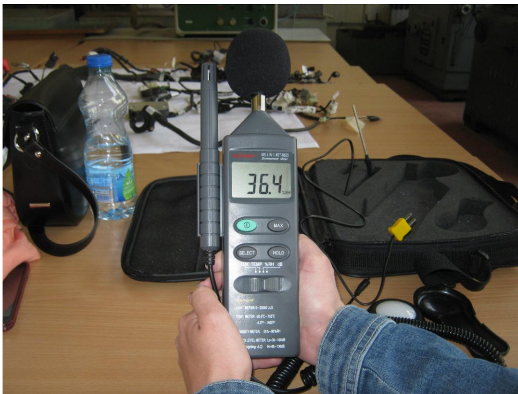
Слика 3.6 Приказ мерења микроклиматских параметара у ЛОМР
