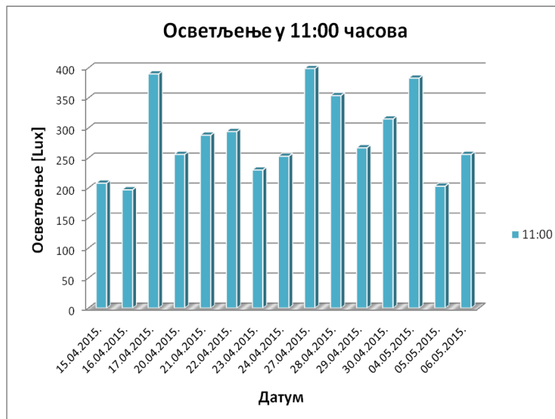
Слика 4.6.1 Измерено осветљење у радионици у 11 часова
