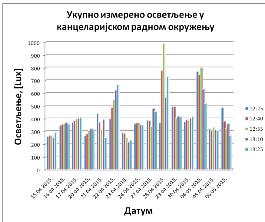
Слика 4.3.6 Укупна измерена осветљеност у канцеларији
