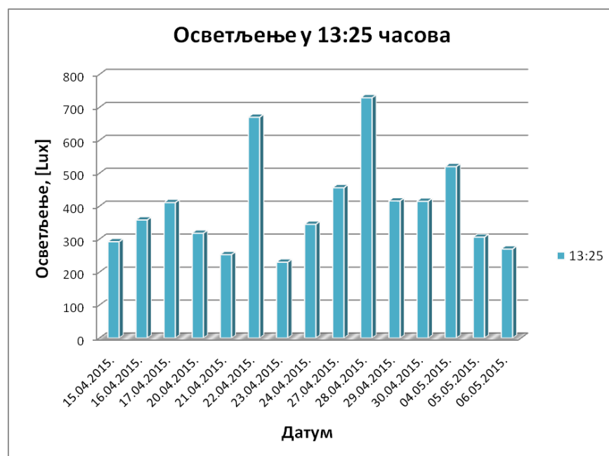
Слика 4.3.5 Измерено осветљење у канцеларији у 13:25 часова
