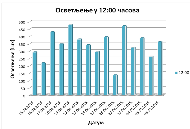
Слика 4.6.5 Измерено осветљење у радионици у 12 часова
