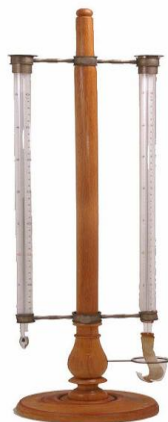
Слика 2.2.1.1 Психрометар са фитиљем по Аугусту [4]
