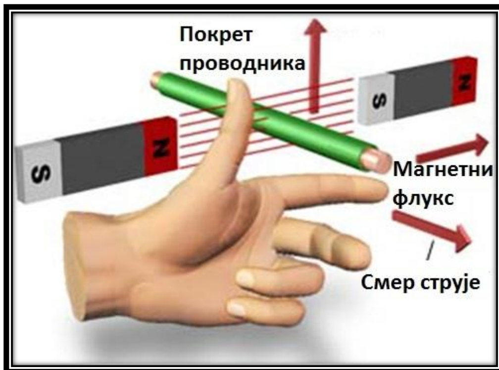
Слика 2. Проводник у магнетном пољу [7]
