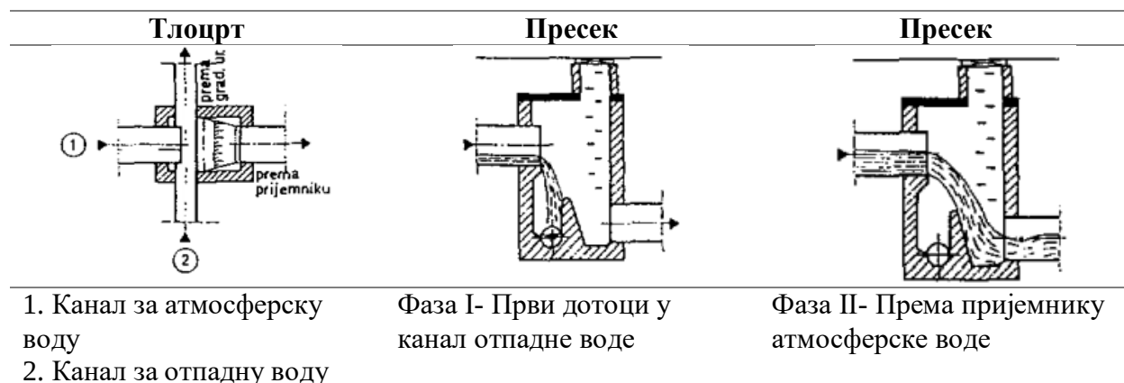
Слика 5. Елементи полуразделног система за одвођење отпадних вода [2]
