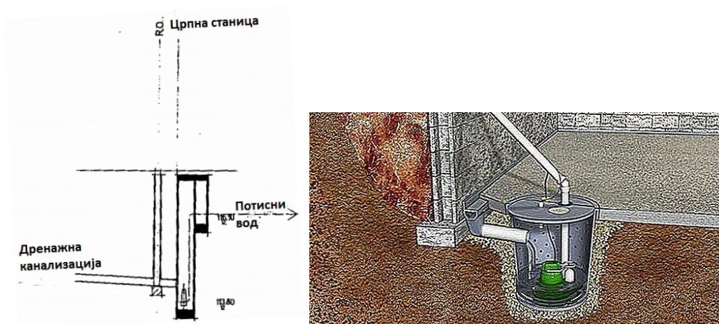
Слика 29. Црпна станица на прикључку дренажне канализације [2]
