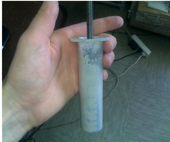
Слика 12. Депоновање глине у шприц
