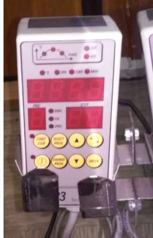
Слика 28. Контролер за програмирање пећнице
