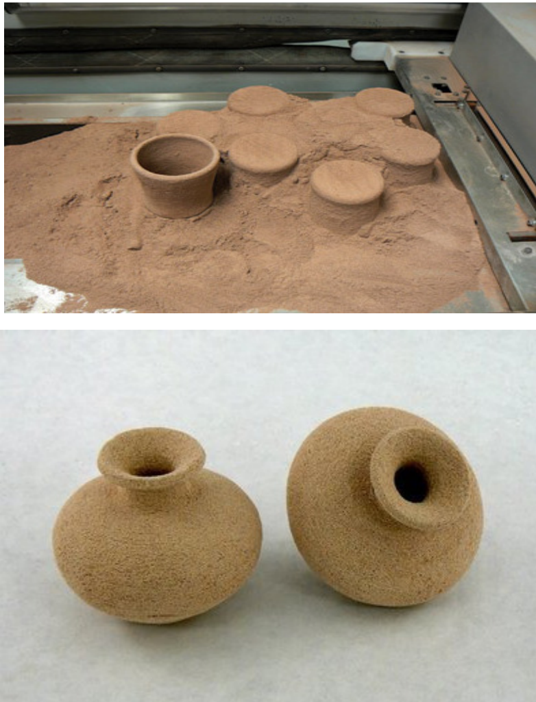
Слика 31. Предмет израђен од глине поступком 3Д штампе [14]
