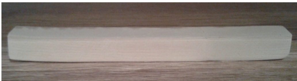
Слика 30. Епрувете после циклуса печења
