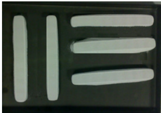
Слика 26. Сушење епрувете на собној температури
