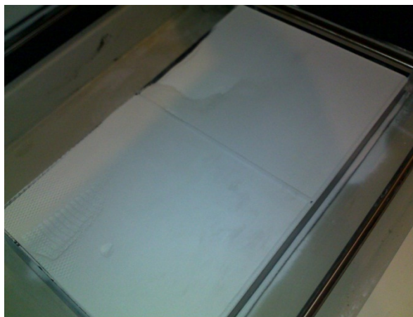
Слика 20. Изглед платформе након пуњења материјалом
