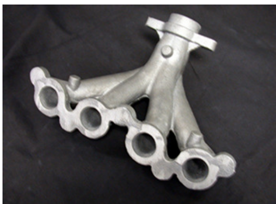
Слика 4. Употреба Zcast технологије за најкраћи пут од модела (лево) до ливених металних делова (десно) – Volkswagen [3]
