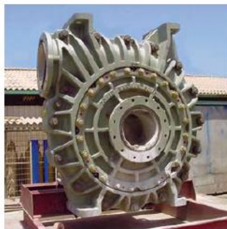
Слика 26 Муљна пумпа типа Warman 6/4AH [7]
