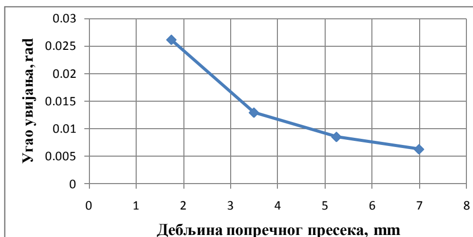
Слика 7.2. Зависност дебљине попречног пресека вратила и угла увијања
