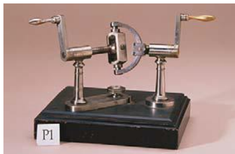
Слика 2.4. Универзални зглоб (Хуков или Карданов), Модел No.P1
