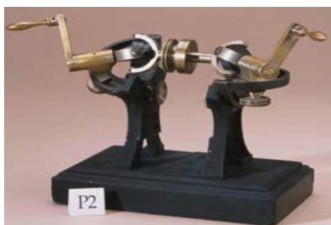
Слика 2.5. Модел удвојеног карданског зглоба, Модел No.P2
