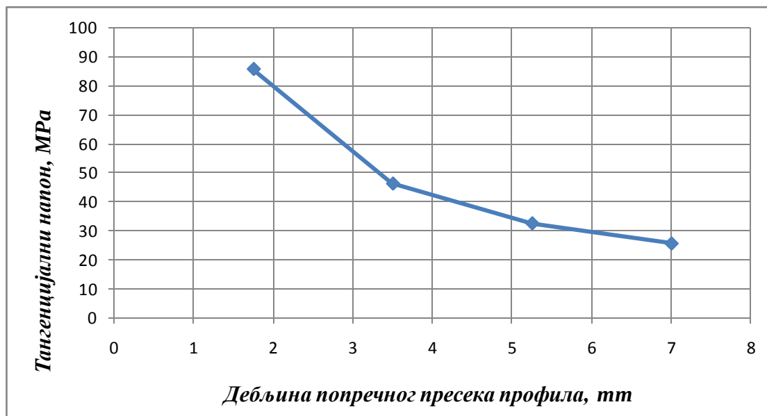
Слика 7.4. Зависност дебљине зида попречног пресека вратила и тангенцијалног напона
