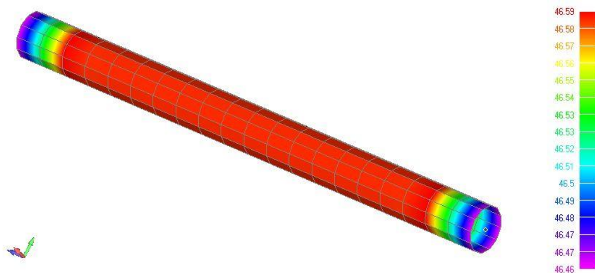
Слика 6.9. Расподела тангенцијалног напона услед увијања челичног вратила, \text{MPa}
