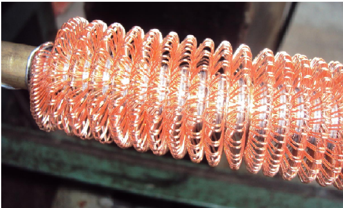
Слика 4.3.6 Спиралне жице конвектора
