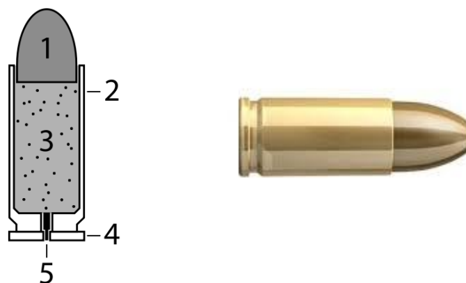
1-пројектил, 2-чаура, 3-барутно пуњење, 4- део за извације из цеви, 5-метална капсула са иницијалним пуњењем
