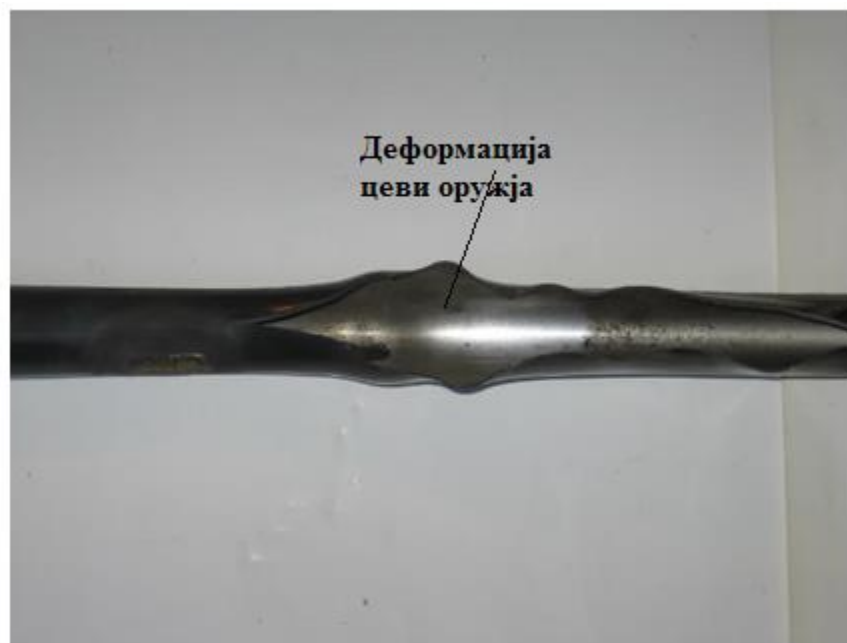
Слика 17: Дефдормација цеви оружја, [1].
