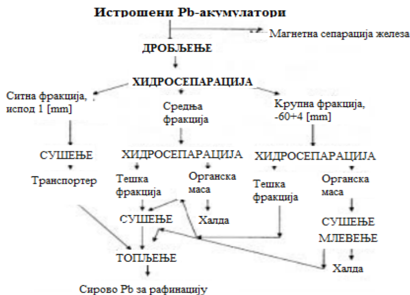
Слика 13. Основна технолошка шема прераде Pb-акумулатора хидросепарацијом [9]
