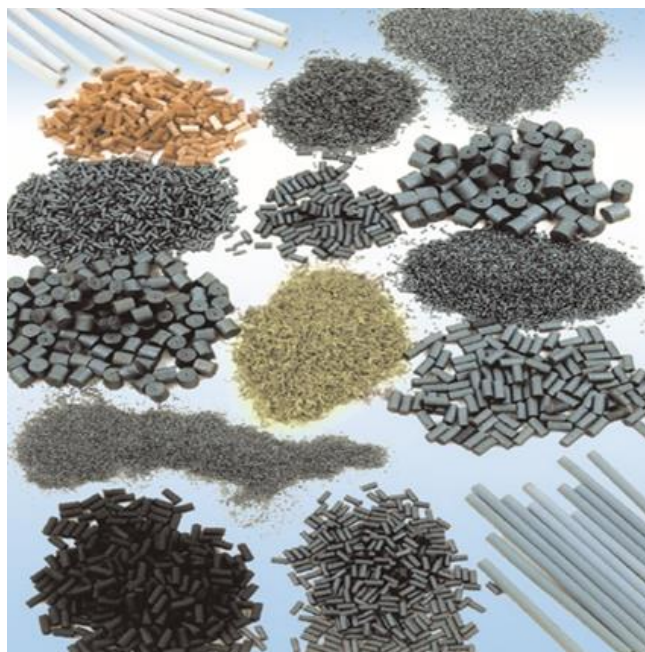
Слика 11. Геометријски облици барутног зрна [13]
