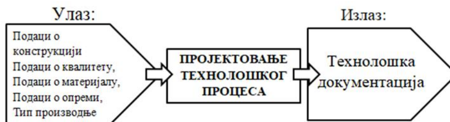
Слика 5.2. Шема пројектовања технолошког процеса [12]
