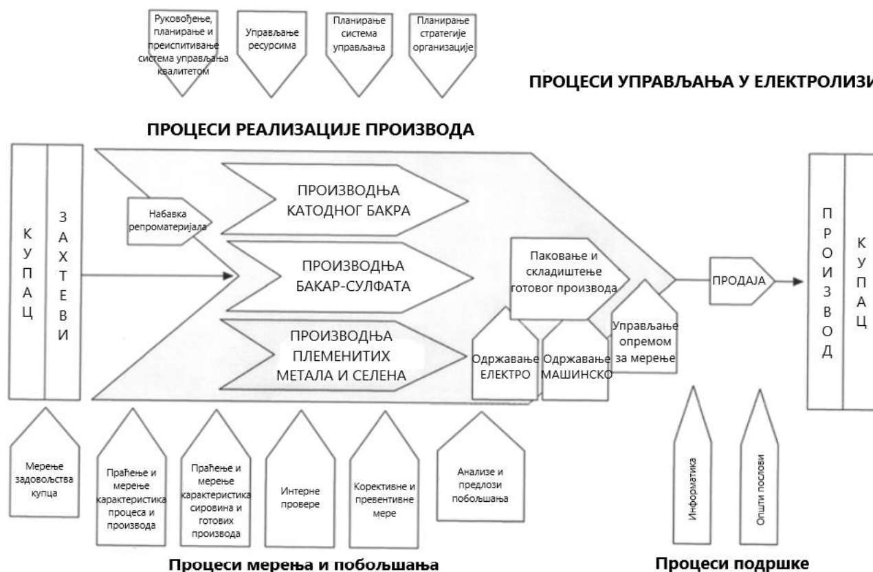
Слика 4.1. Процесни модел система управљања квалитетом електролизе [2]
