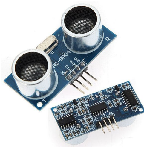
Слика 3.14 Ултразвучни сензор растојања HC-SR04
