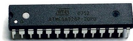
Слика 3.7 Микроконтролер ATmega328P
