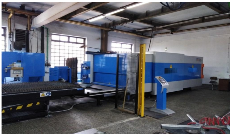
Слика 23. Ласер Прима (Prima Power Platino Fiber) из производног погона фабрике Застава оружје [40]
