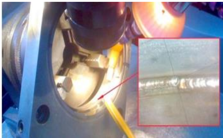
Слика 21. Приказ заваривања ласером на тешко приступачном месту [38]
