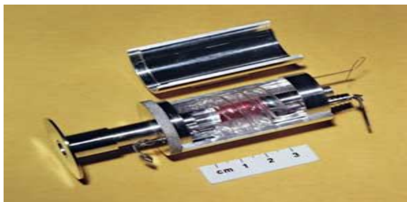
Слика 2. Први успешан радни ласер, који је конструисао Теодор Мејман [19]
