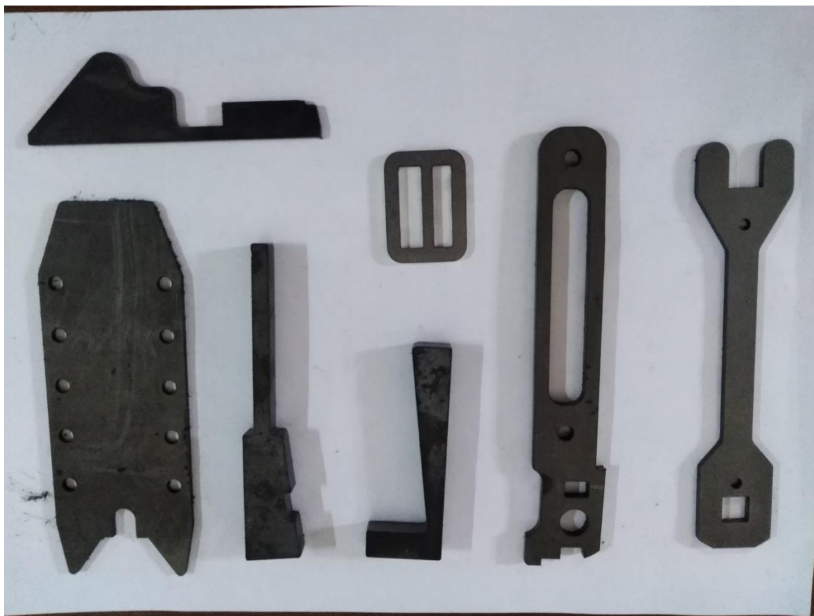
Слика 24. Приказ готових делова добијених сечењем, применом ласера [40]
