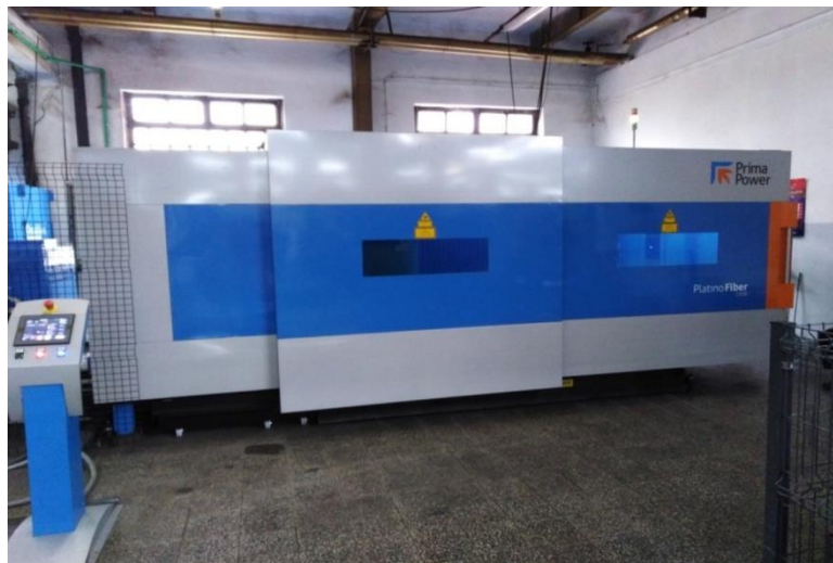
Слика 25. Ласер Прима (Prima Power Platino Fiber) [40]
