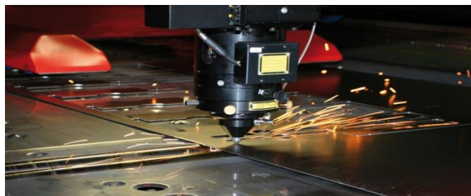
Слика 5. Примена ласера у индустрији за сечење [22]
