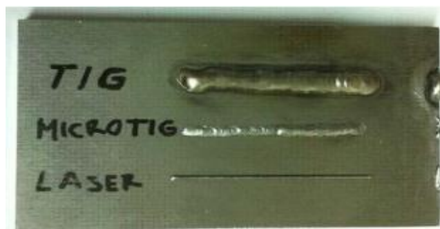
Слика 20. Приказ три вара добијана са три различита поступка заваривања [37]
