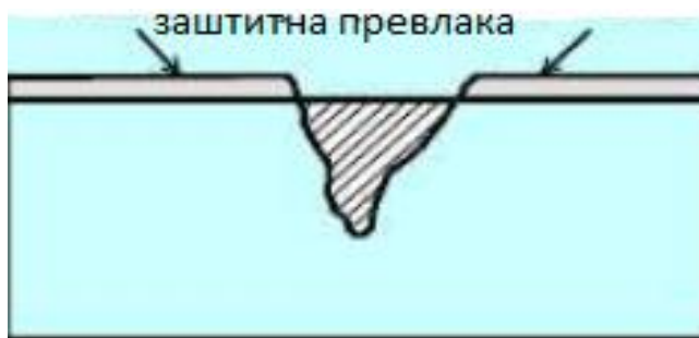
Слика 8. Питинг корозија услед прекида заштитне превлаке [1]
