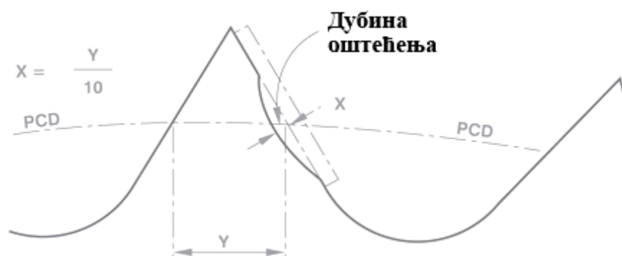
Слика 4.4. Индикатор хабања зуба ланчаник, [11]
