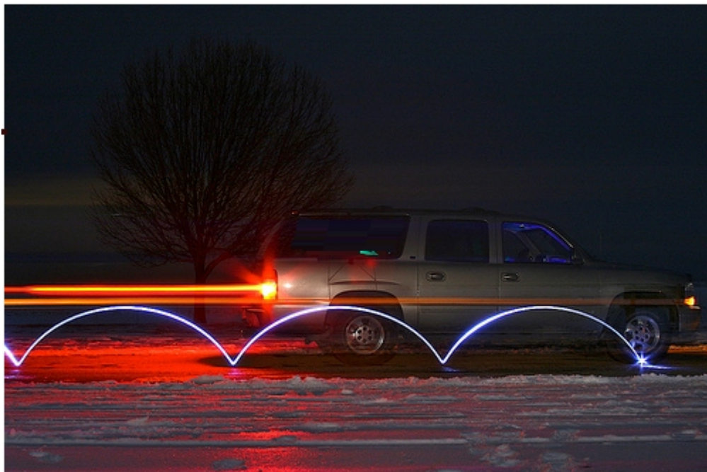
Слика 3.11 Замишљена циклоида коју описује тачка на точку возила
