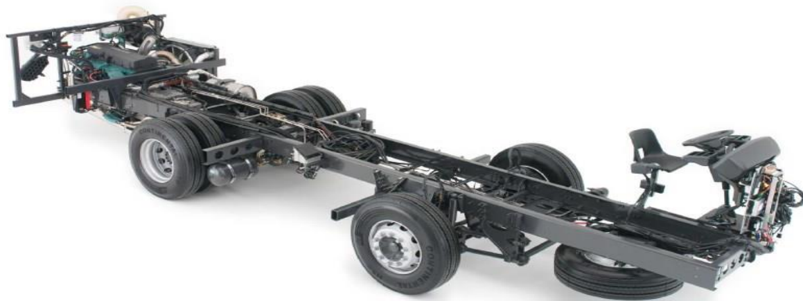
Слика 15. Аутобуска шасије фирме MAN, са рамом као носећим елементом[12]
