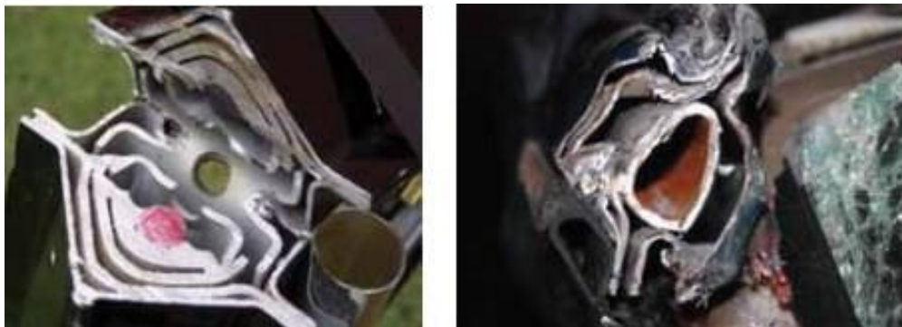
Слика 20. Средњи носач возила (лево) и предњи носач возила (десно) израђени од бором легираног челика[24]
