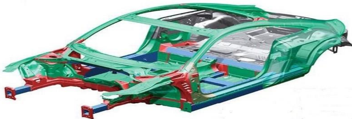
Слика 10. Решеткаста структура каросерије – Audi TT Coupe[13]
