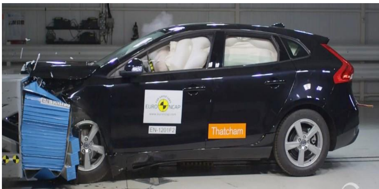
Слика 46. Тест чеоног удара [45]
