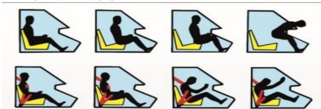
Слика 38. Симулација кретања тела са и без сигурносног појаса приликом судара [35]
