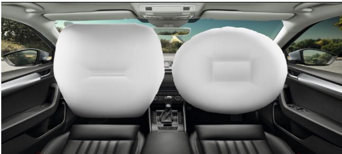
Слика 33. Ваздушни јастук за возача и сувозача (SkodaSuperb) [32]
