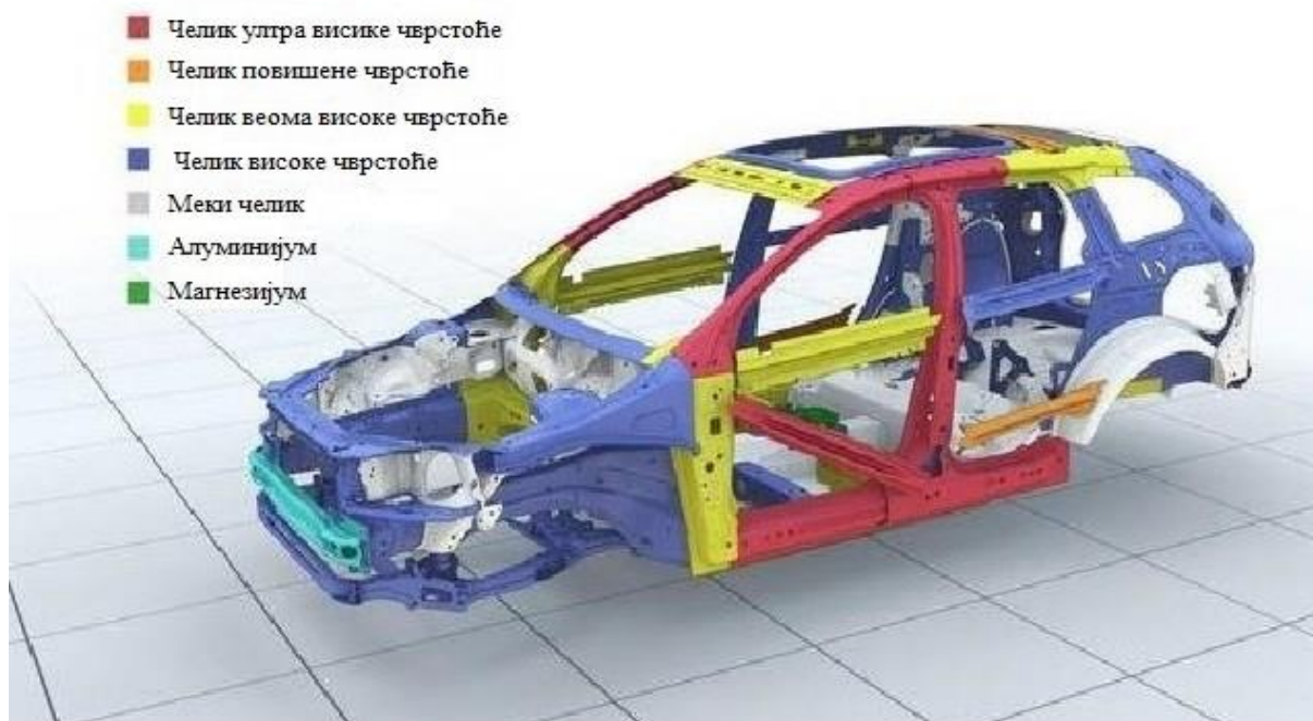
Слика 19. Употреба различитих врста челика, алуминијума и магнезијума [25]
