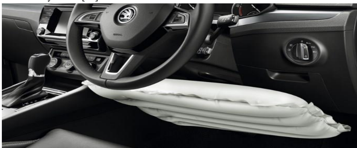
Слика 35. Ваздушни јастук за колена vozača (Škoda Superb) [32]
