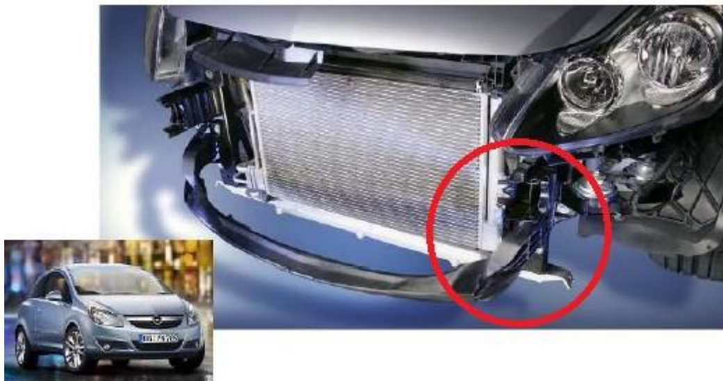
Слика 29. Доње укрућење браника – пример уградње на возилу OpelCorsa[3]
