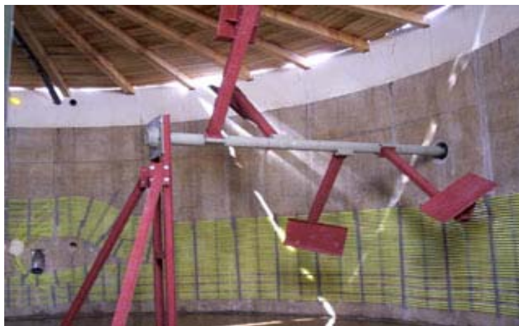
Слика 27 : Мешање третираног материјала уз помоћ вретена са лопатицама
