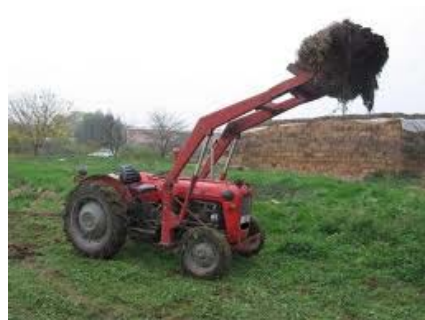
Слика 48: Тракторска утоварна кашика
