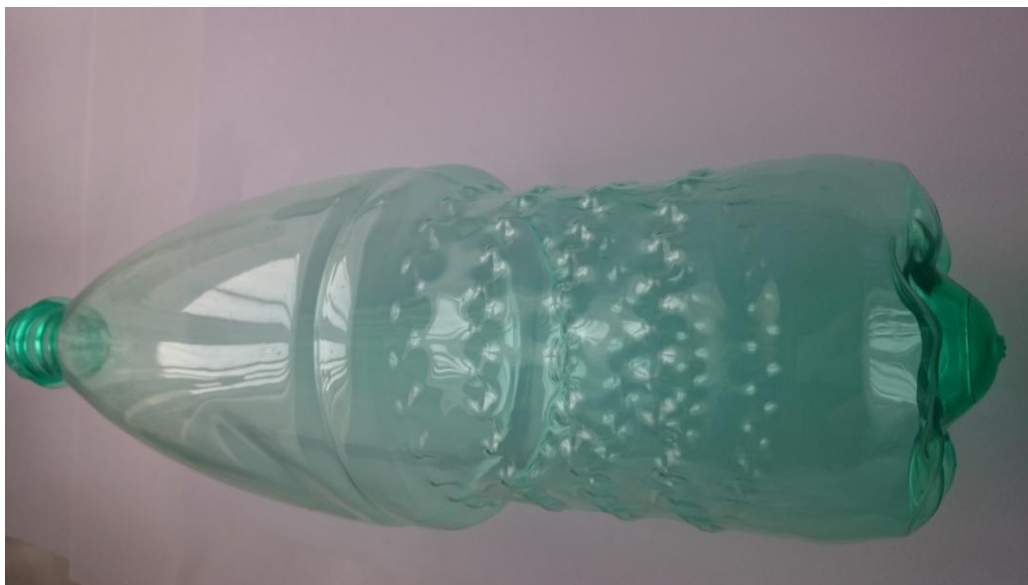
Слика 5.8 Боца која није прошла главни процес дувања
