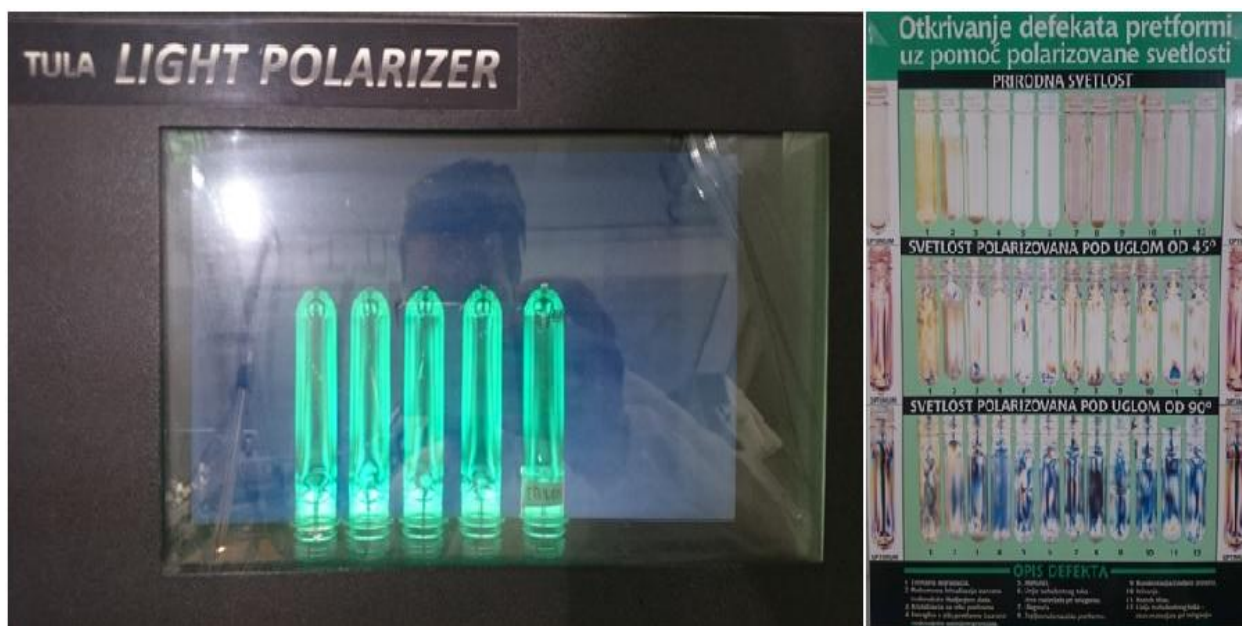
Слика 5.14 Процес контроле на поларизатору (лево), упоредна табела са дефектима (десно)
