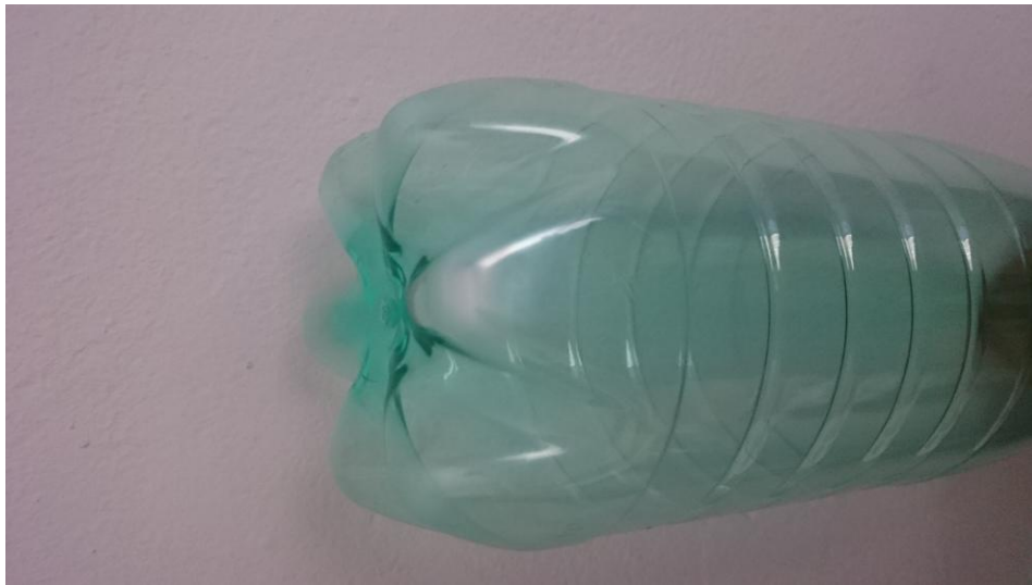
Слика 5.5 Дефекат у виду седефастог сјаја на дну боце
