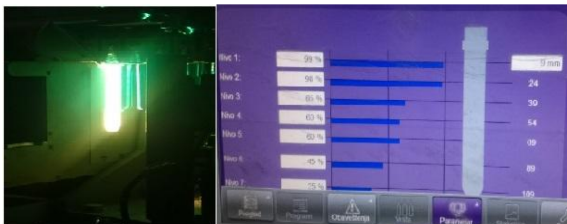
Слика 4.3. Улазак претформе у пећ (лево) и кориснички интерфејс са температурама у зонама претформе (десно)
