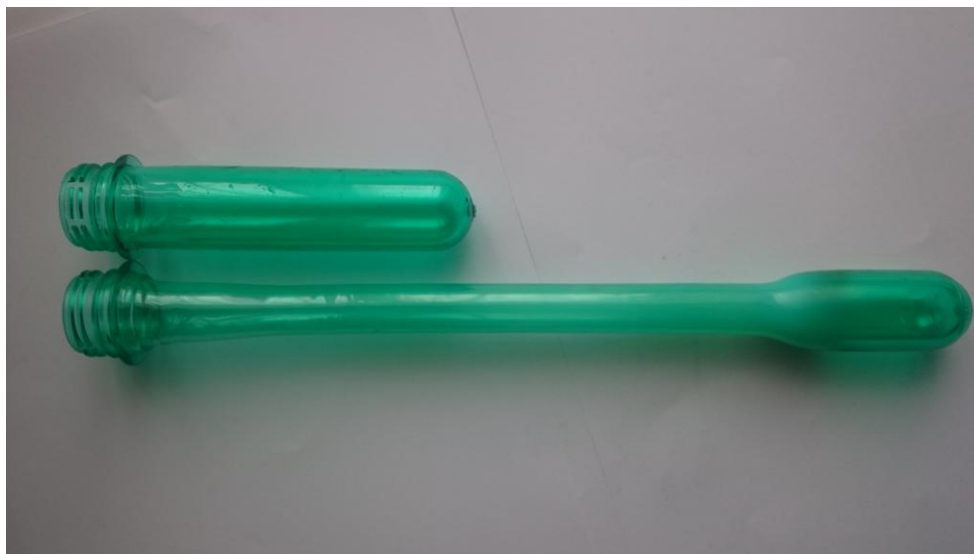
Слика 5.10 Истегнута претформа без поступака дувања
