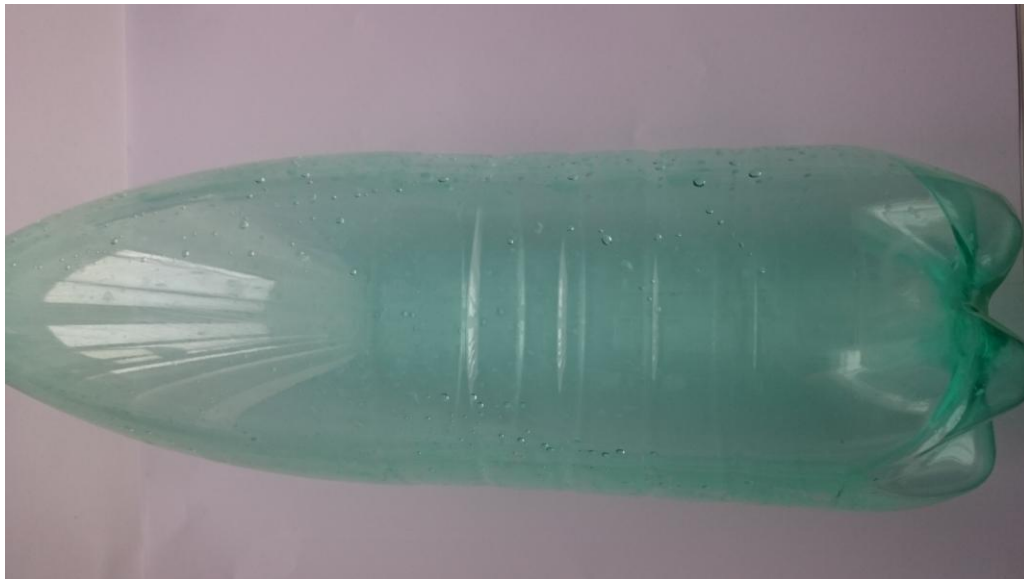
Слика 5.6 Дефекат у виду задебљалог дна
