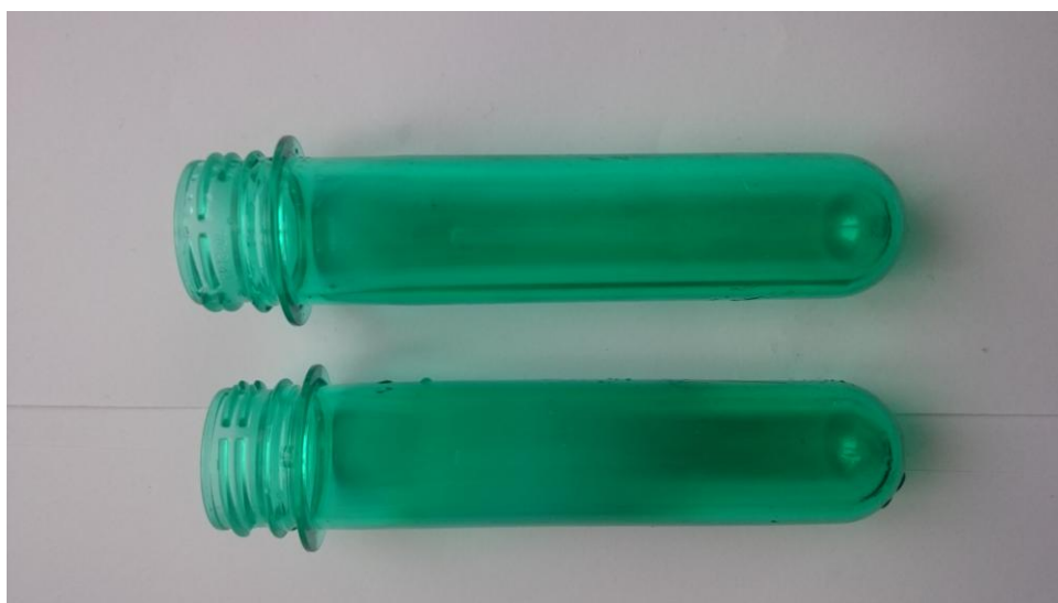
Слика 5.12 Прегрејана епрувета
