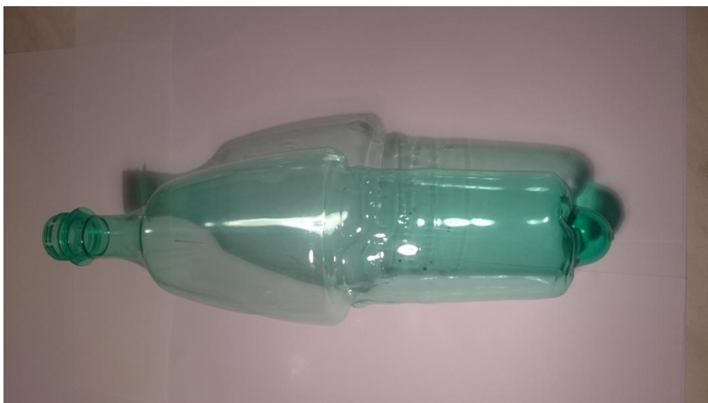
Слика 5.9 Боца урађена само постоком преддувања
