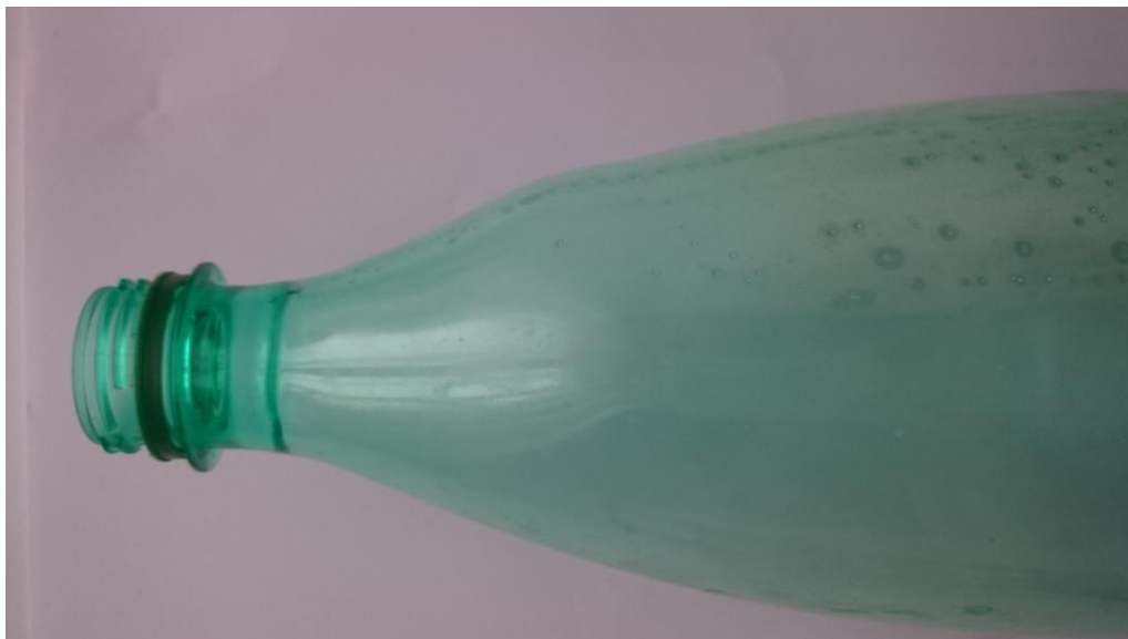
Слика 5.9 Боца се дефектом у виду балона у горњем делу боце у пределу рамена
