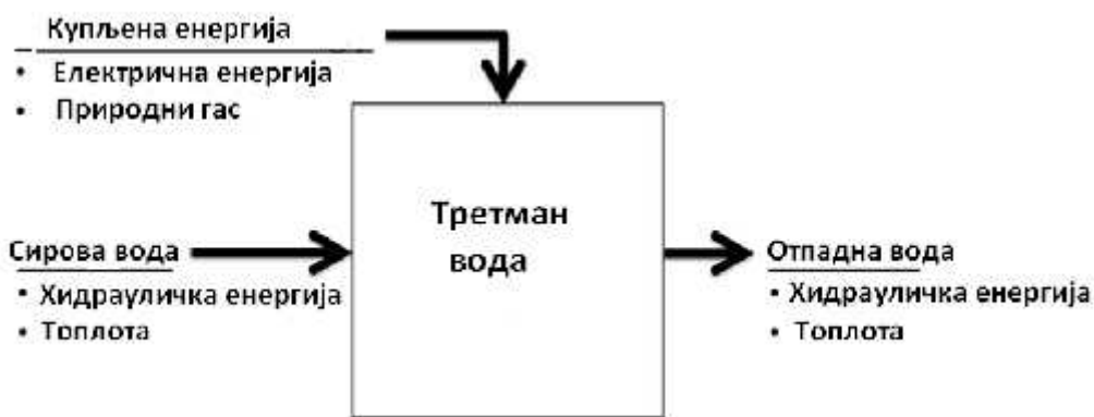
Слика 8. Енергетски биланс у постројењу за пречишћавање вода
