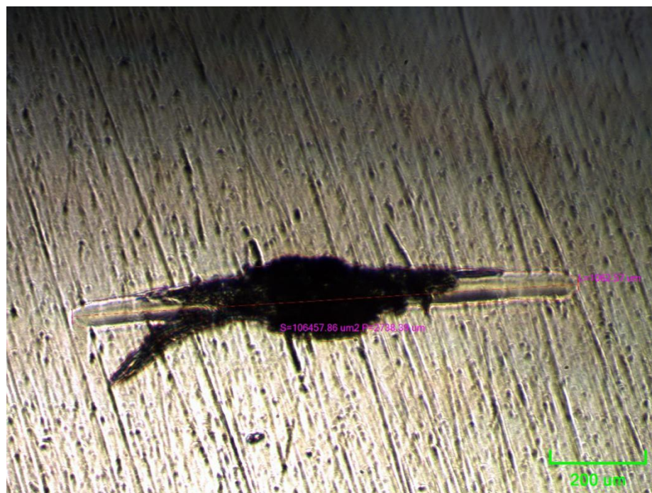
Слика 6.2.7 Траг хабања на алуминијумској плочици после поновљеног процеса клизања са обележеном површином и дужином (нормално оптерећење 900mN, брзина клизања 30mm/s)
