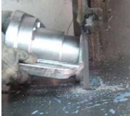
Слика 5. Одстрањивање уливних канала и хранитеља одливка на тракастој тестери
