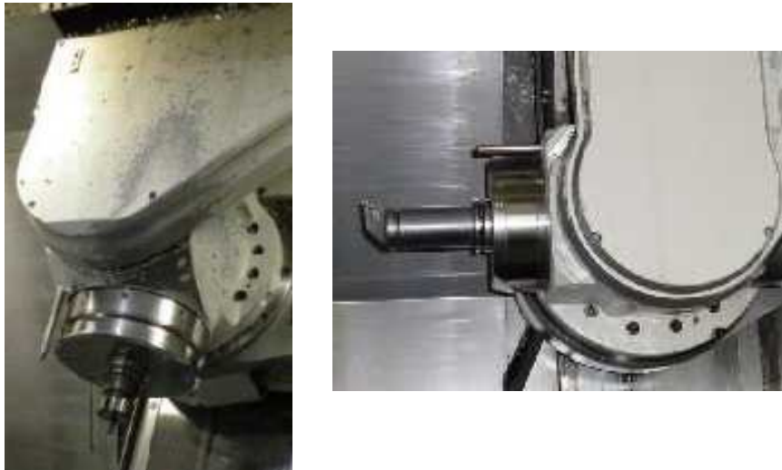
Слика 23. Носач окретног алата и стругарског ножа машине
