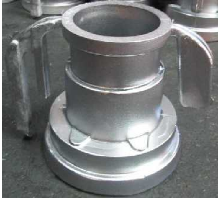
Слика 2. Изглед задатог изливеног дела након уклањања калупа
