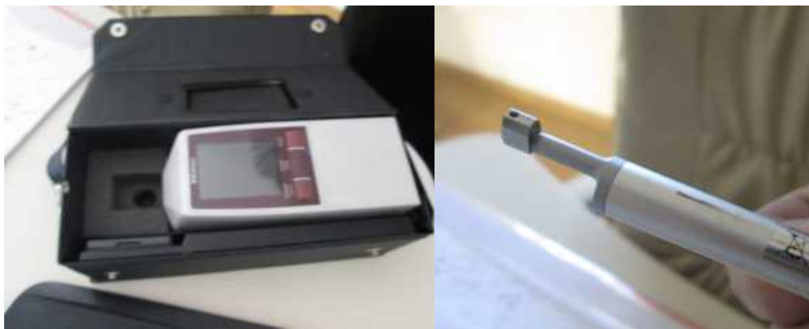
Слика 51. Мерни апарат за мерење храпавости површине
