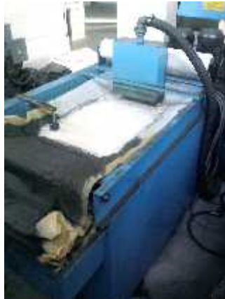
Слика 30. Резервоар за емулзију
