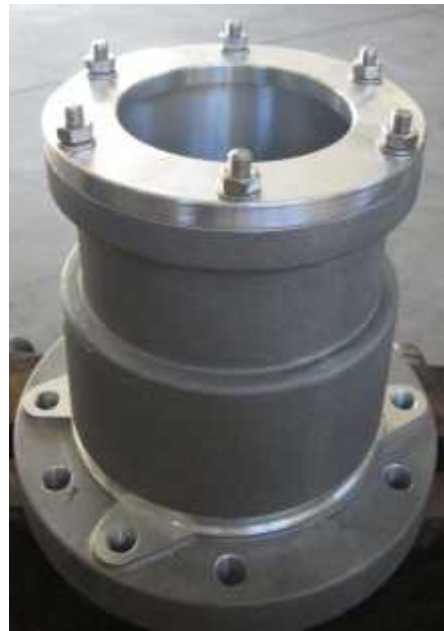
Слика 48. Коначни 3D модел и коначни изглед дела након обраде
