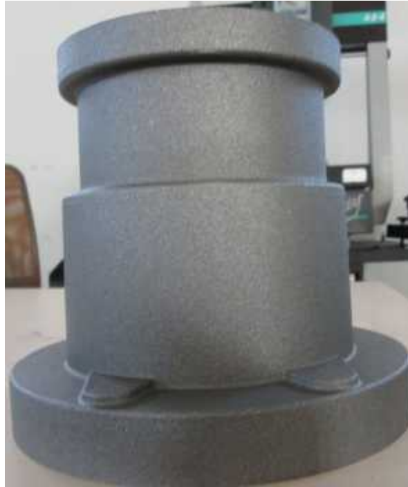
Слика 15. Готов одливак са извршеном термичком обрадом
