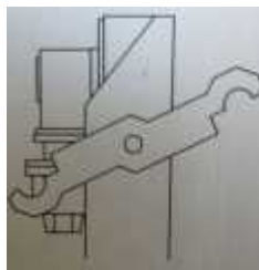
Слика 28. Двострана механичка рука за аутоматску измену алата
