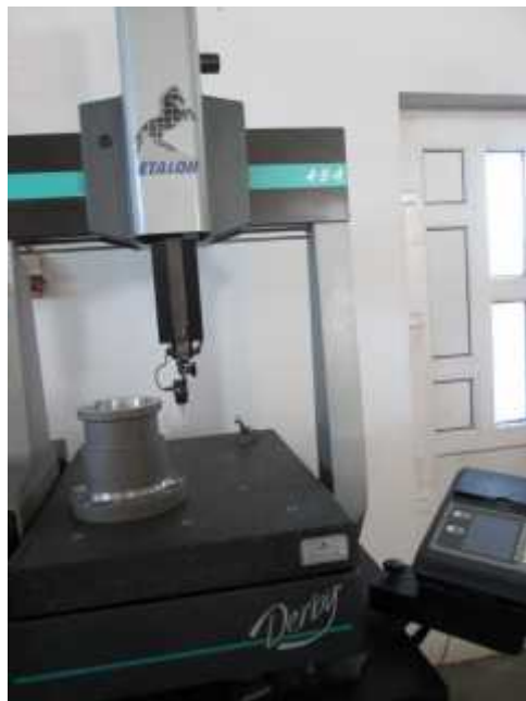
Слика 50. Мерна машина Etalon Derby 4-5-4
