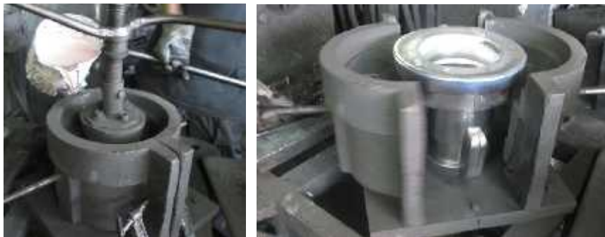
Слика 4. Уливање течене легуре алуминијума у алат за ливење и отварање алата
