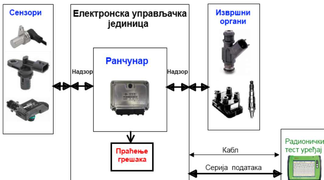
Слика 16. Шематски приказ самодијагностике система за управљање радом мотора који користе систем напајања возила горивним Motoronic ME7 [12]
