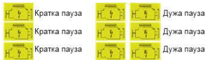
Слика 23. Низ светлосних кодова – код грешке 12 (почетак процедуре) [3]
