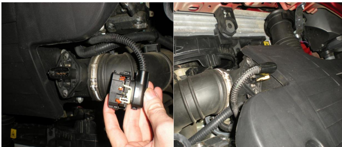
Слика 70. Поправка (замена) отказаног сензора [31]
