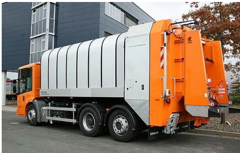
Слика 2.6 Rotopress возило
