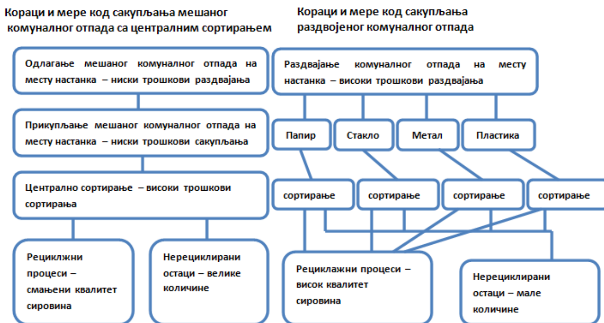
Слика 2.1 Кораци и мере у процесу прикупљања мешаног и одвојеног комуналног отпада
