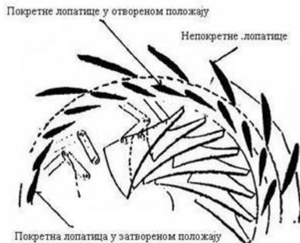
Слика 5.13. Регулациони систем покретних лопатица вертикалне Франсисове турбине [3]
