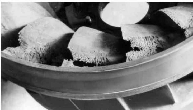
Слика 2.16. Радно коло Франсисове турбине са лопатицама оштећеним кавитацијом [5]
