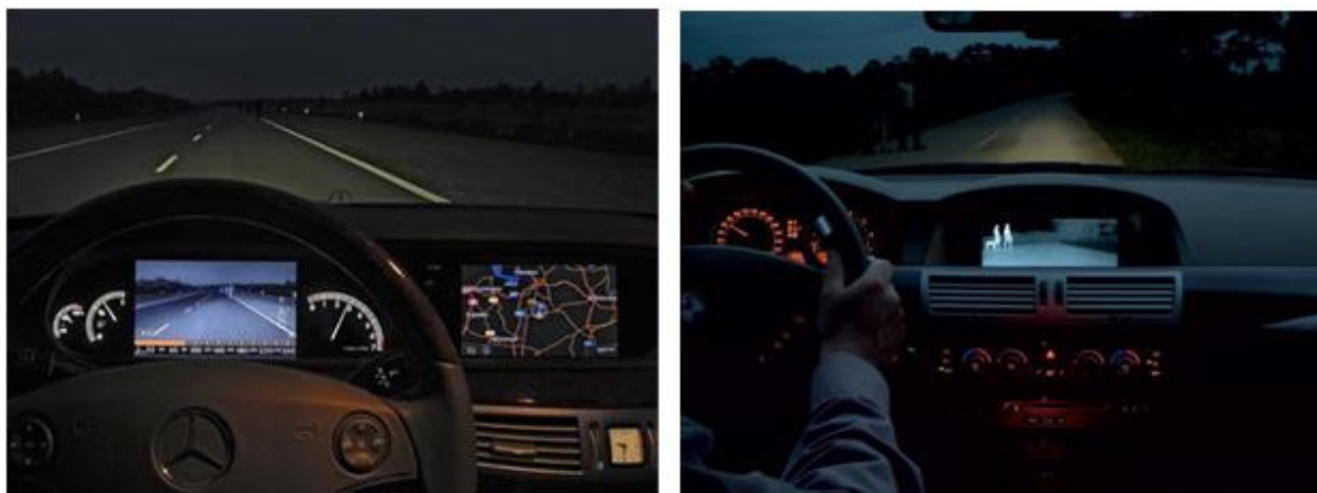
Слика 7.2. Приказ на дисплеју добијен посредством: а) инфрацрвене камере (лево), б) термалне камере (десно) [1]
