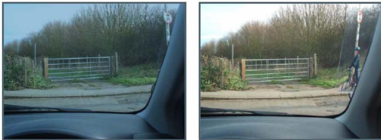
Слика 3.21. Видљивост из возила са и без примене система Serravista [1]
