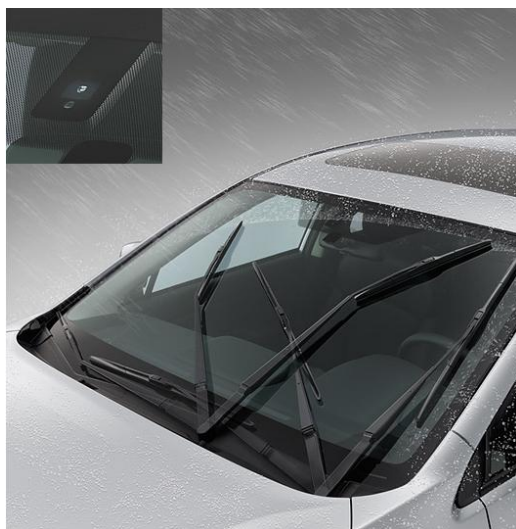
Слика 7.19. Систем за аутоматско укључивање брисача стакла на возилу [20]
