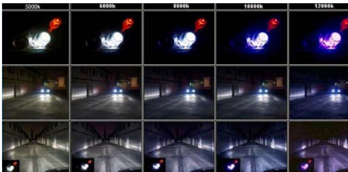
Слика 6.7. Интензитет светла ксенонских сијалица у зависности од температуре [19]
