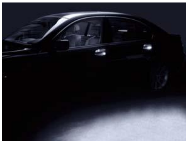
Слика 5.6. Светла за улазак/излазак из возила активирана даљинским кључем [10]
