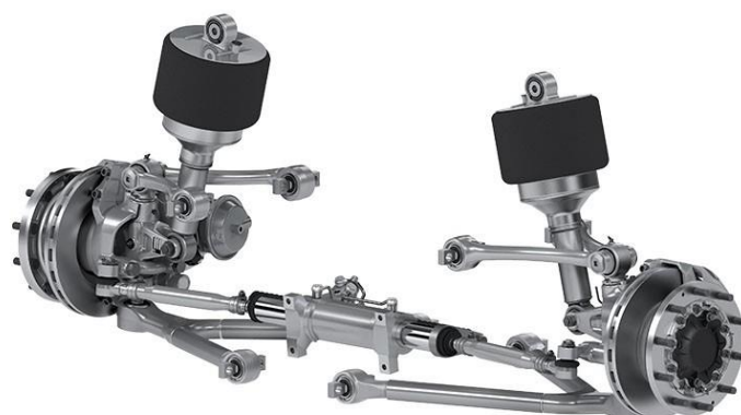
Слика 30. Систем независног ослањања предње осовине ITS 80 F произвођач ZF [27]
