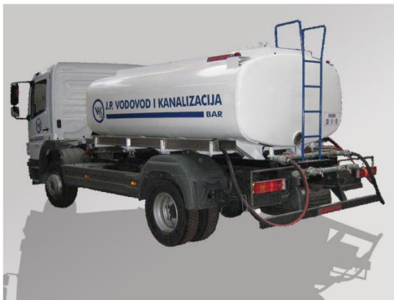
Слика 10. Ватроспрем цистерна за прање и поливање улица са надградњом АС-60.08 [4]
