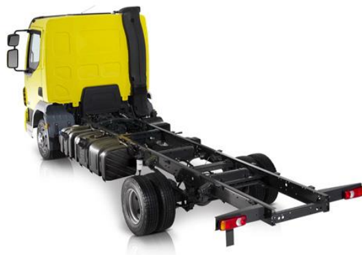
Слика 24. Савремена концепција погона камиона са смештајем мотора и кабине у предњем препусту и погоном на задњем мосту [25]
