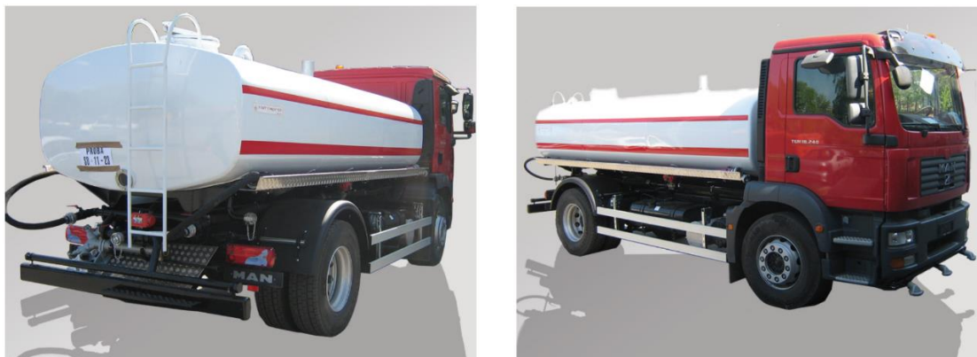
Слика 9. Цистерна за прање и поливање улица са надградњом произвођача Ватроспрем AC-100.08 [4]
