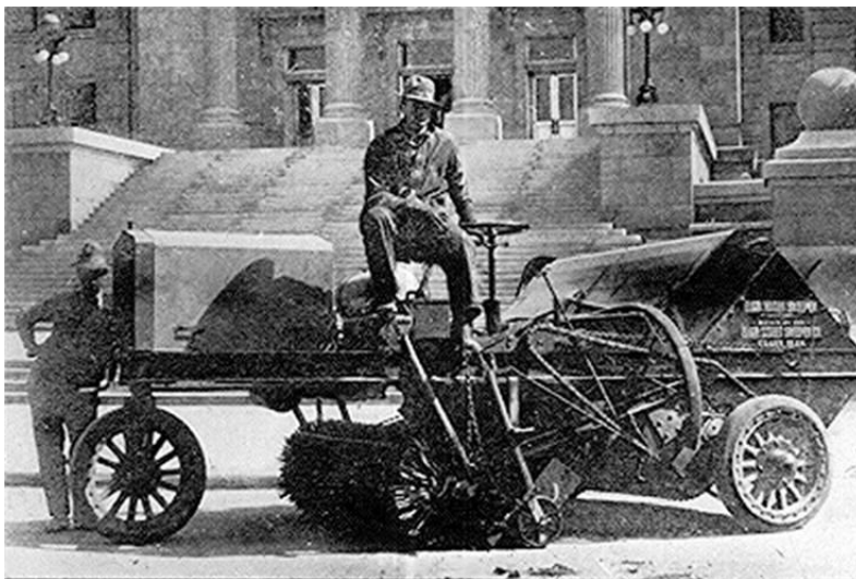
Слика 2. Машина за чишћење улица компаније Елдин, САД 1914. година [1]
