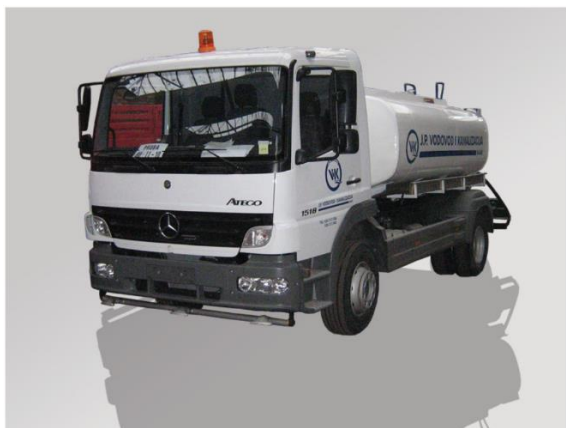
Слика 10. Ватроспрем цистерна за прање и поливање улица са надградњом АС-60.08 [4]
