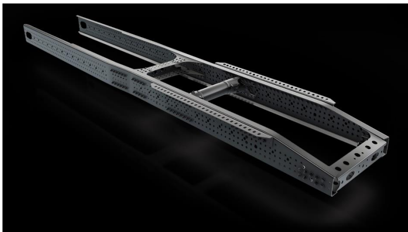
Слика 25. Носећа структура – шасија, произвођача Mercedes-Benz [26]
