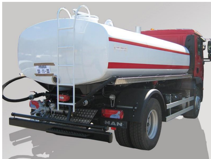
Слика 34. Монтиран резервоар за воду са одговарајућом пратећом опремом произвођача „Ватроспрем“ [4]
