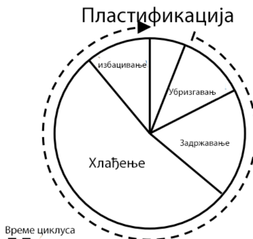
Слика 10. Комплетан циклус бризгања
