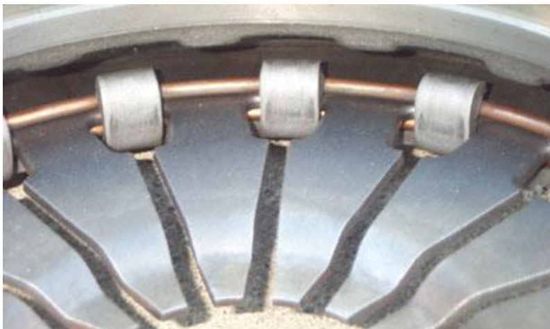
Слика 48. Канце потисне плоче закачене за тањирасту опругу [30]
