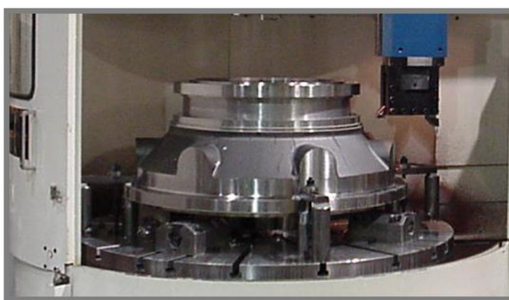
Слика 2.6 Обрада стругањем на вертикалном CNC стругу
