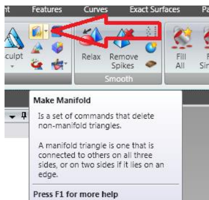
Слика 50. Алатком make manifold програм аутоматски прегледа целу површину у потрази за троугловима који нису у потпуности (са све три ивице) повезани у целину са остатком модела и затим их повезује или брише
