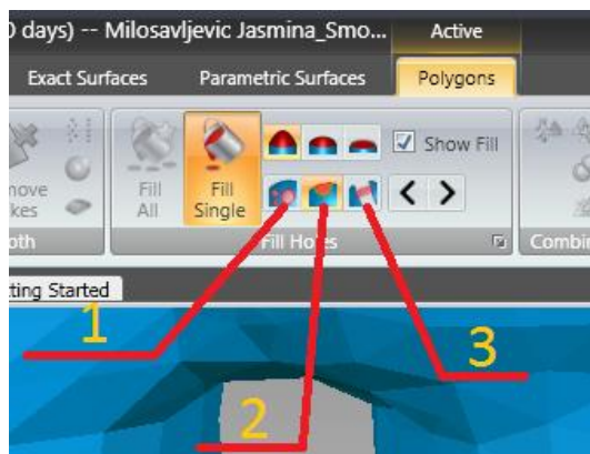
Слика 47. Алатка fill single ; позицијом 1 означена је опција комплетног аутоматског попуњавања рупе; позицијом 2 делимично попуњавање рупе; а позицијом 3 грађење "мостића".
