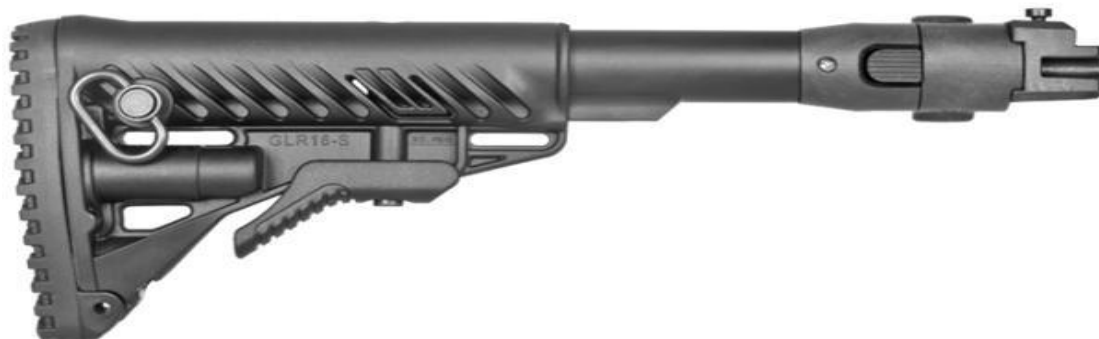
Слика 5.2. Телескопски кундак – типа М-4 (могућност подешавања по хоризонтали, са четири дужине развлачења) од полимерске матрице са стакленим влакнама и са опружним апсорбером [12].
