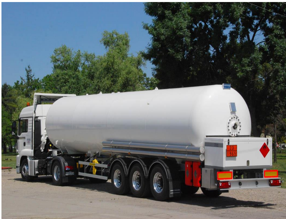
Слика 7. Обележено возило за транспорт течног нафтног гаса
