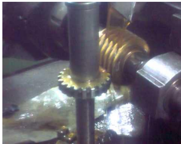
Слика 2.3 Израда цилиндричног зупчаника
