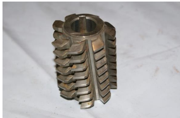
Слика 2.4 Модулно одвално глодало
