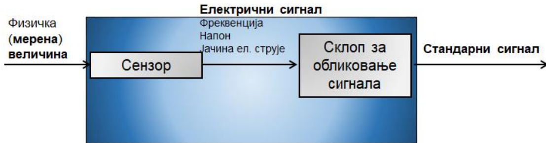
Слика 16. Шема мерног претварача (сензора) [1]
