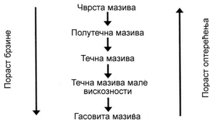
Слика 3.1. Утицај брзине и оптерећења на избор групе мазива,[3]
