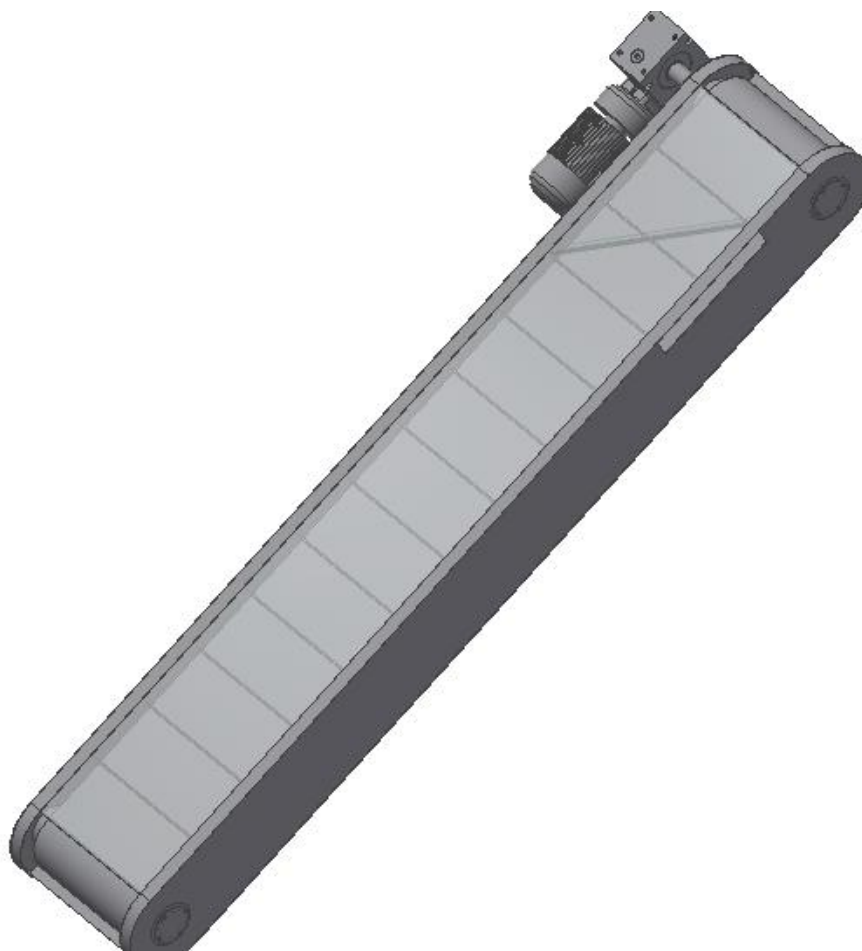
Слика 99. Елеватор са ПВЦ траком
