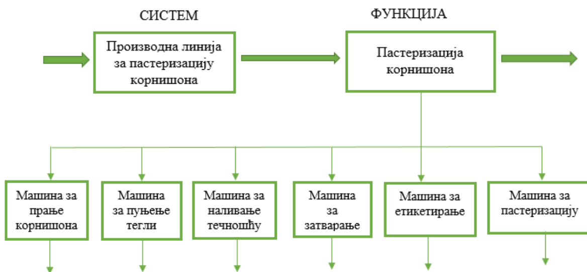
Слика 1. Општа функција производне линије за пастеризацију корнишона
