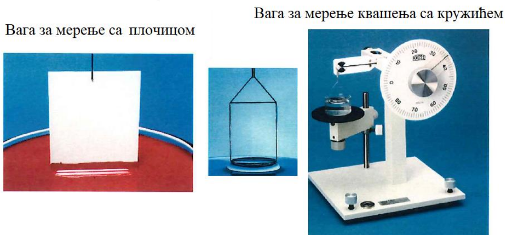
Слика 15. Ваге за мерење квашења (тензиометар) [5].
