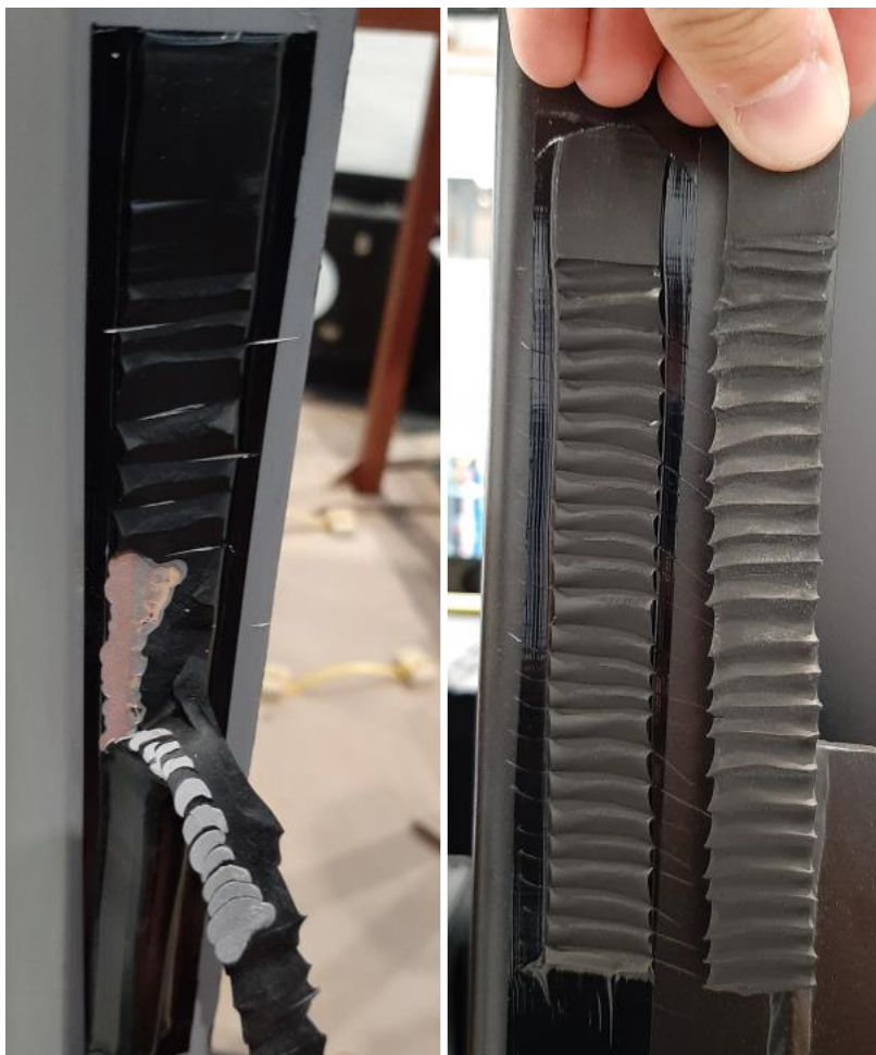
Слика 26. Лоша радна проба и добра радна проба. [6]
