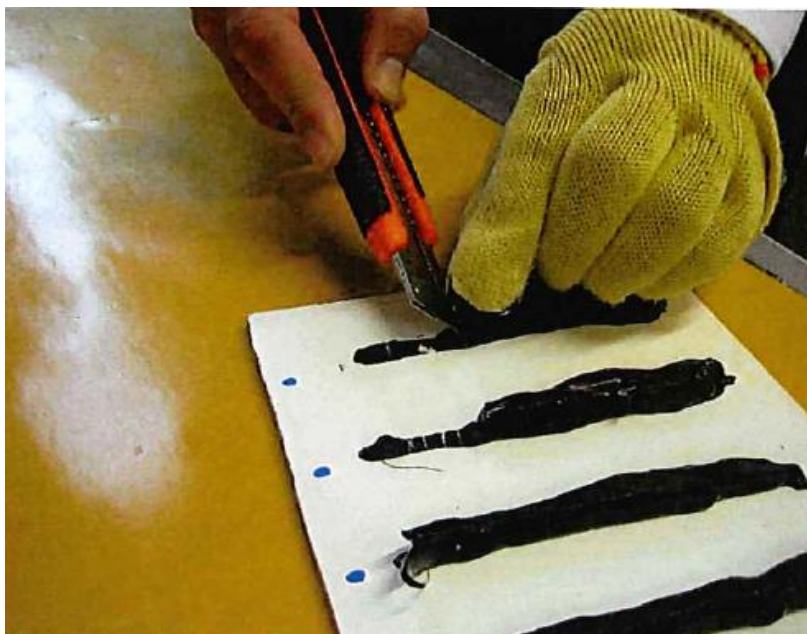
Слика 24. Сечење пробе приликом затезања. [5]
