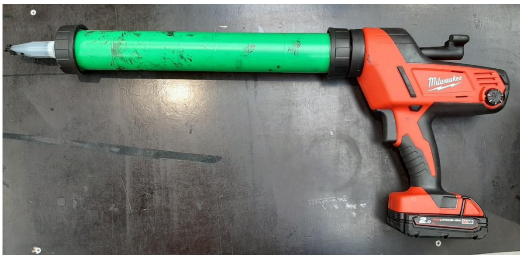
Слика 20. Пиштољ за наношење лепка Sikaflex. [6]
