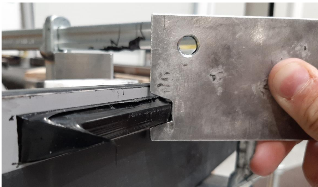
Слика 23. Облик гусенице и шаблон за обликовање. [6]
