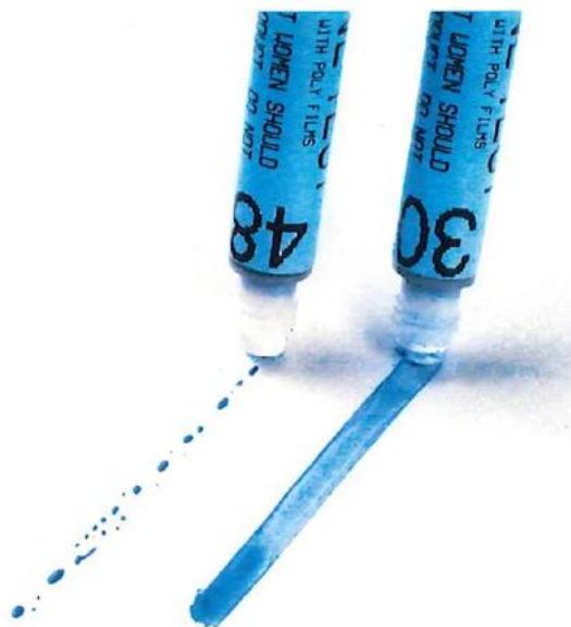
Слика 17. Маркер за проверу површинске енергије супстрата [5].
