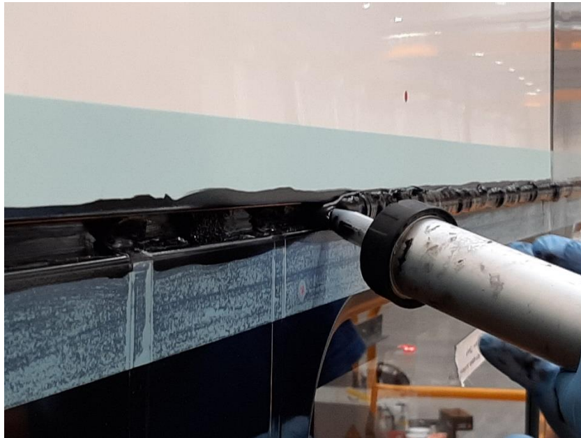
Слика 21. Наношење лепка на површину [6]
