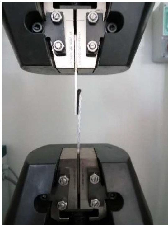
Слика 28. Узорак постављен у чељусти кидалице [11]
